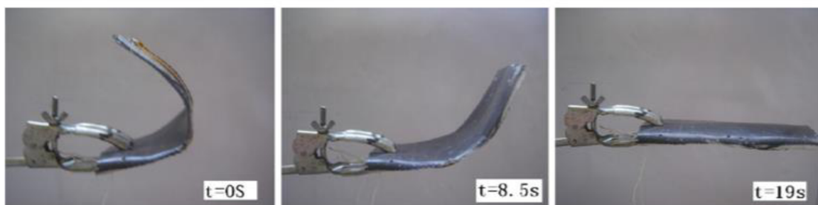
Obrázek 2.2.7 Rozvinutí kompozitu, tvořeného polymerem s tvarovou pamětí [3]
