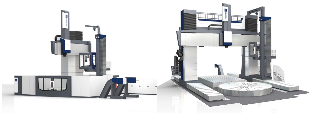
Obrázek 2.2: Jednostojanový (vlevo) a dvoustojanový (vpravo) karusel firmy ČKD [6]
