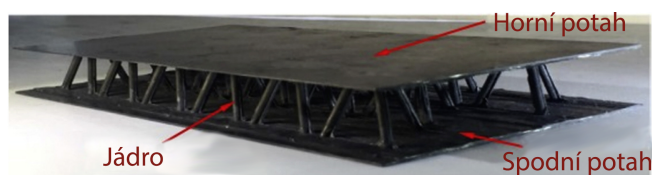
Obrázek 4.6: Sendvičová struktura s příhradovým jádrem [20]
