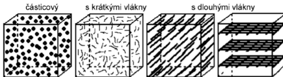
Obrázek 4.3: Výztuže v kompozitním materiálu [16]
