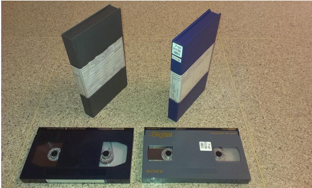
Příloha č. 3: Analogová kazeta Betacam SP + Digitální kazeta Digital Betacam (obrázek 2)
