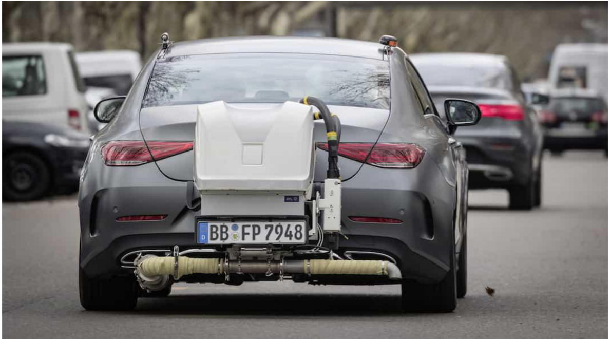
Obr. 2 Automobil s RDE testovací aparaturou v provozu
