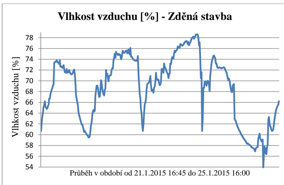
Graf 4: Průběh vlhkosti vzduchu za dané období – Zděná stavba
