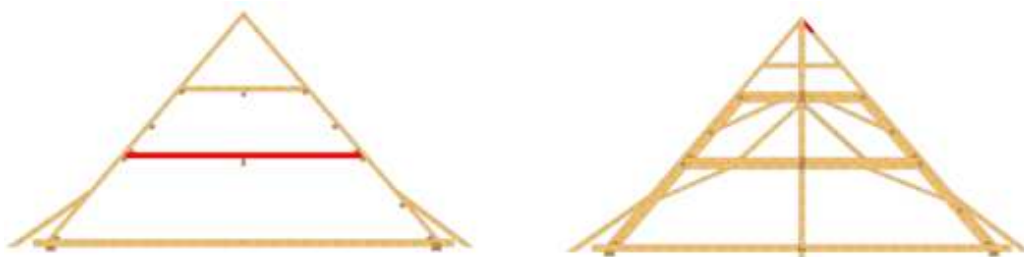
Obr. 44 Schematicky znázorněna vazba 16 a vazba 17 (červená – poškozené prvky)
