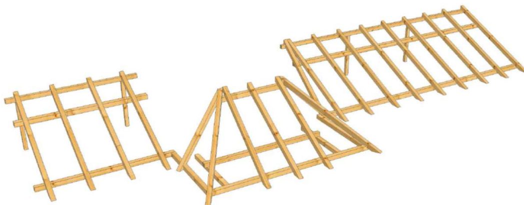
Obr. 33 Krov pultové střechy na severní straně
