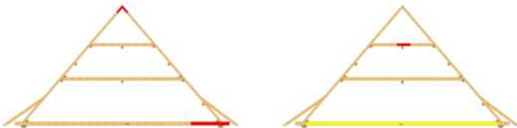
Obr. 42 Schematicky znázorněna vazba 11 a vazba 12 (žlutá – chybějící prvky, červená – poškozené prvky)
