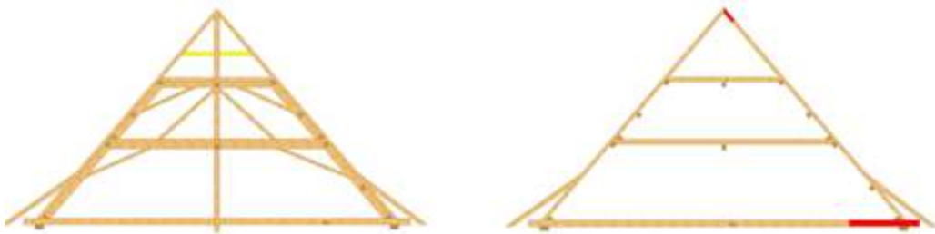
Obr. 41 Schematicky znázorněna vazba 9 a vazba 10 (žlutá – chybějící prvky, červená – poškozené prvky)
