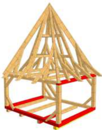
Obr. 51 Jižní věž - pohled ze severozápadu (červená – poškozené prvky, žlutá – chybějící prvek)
