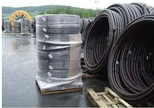
Obr. 22 Polyethylen PE 100 pro sondu geotermálního vrtu
