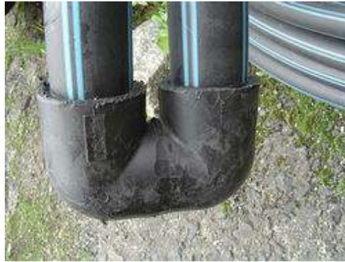
Obr. 24 Neodborně zhotovená sonda pro geotermální vrt
