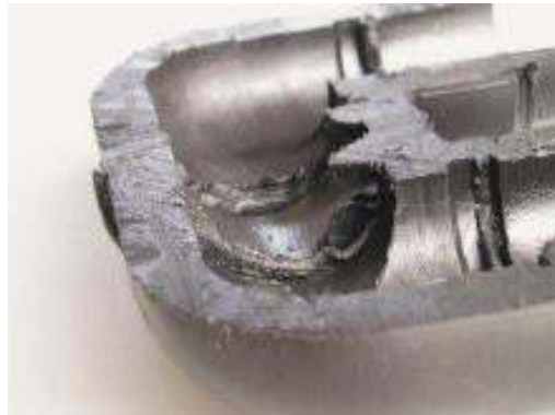
Obr. 25 Řez nevhodně provedenou sondou
