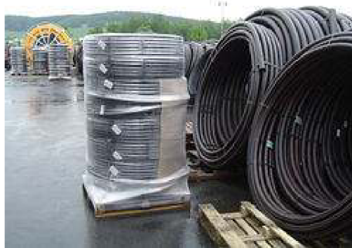
Obr. 22 Polyethylen PE 100 pro sondu geotermálního vrtu
