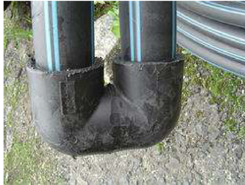
Obr. 24 Neodborně zhotovená sonda pro geotermální vrt
