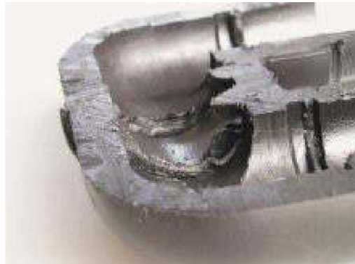
Obr. 25 Řez nevhodně provedenou sondou
