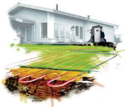
Obr. 17 Tepelné čerpadlo země–voda (plošný kolektor)
