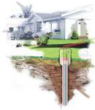
Obr. 20 Tepelné čerpadlo země–voda (geotermální vrt)
