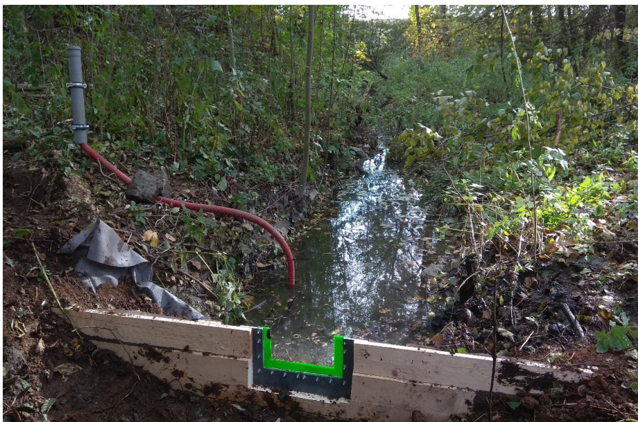
Obrázek č. 4.14 – Vodoměrný profil s online záznamovým zařízením na odtoku z Nesačického rybníka
