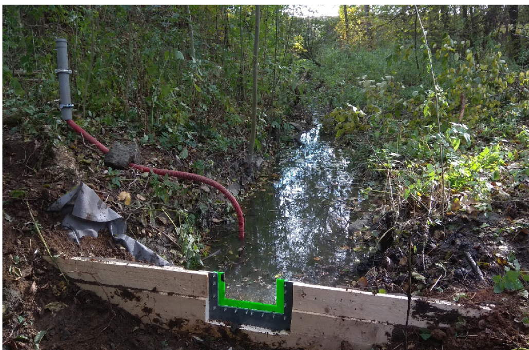
Obrázek č. 4.14 – Vodoměrný profil s online záznamovým zařízením na odtoku z Ne-svačilského rybníka
