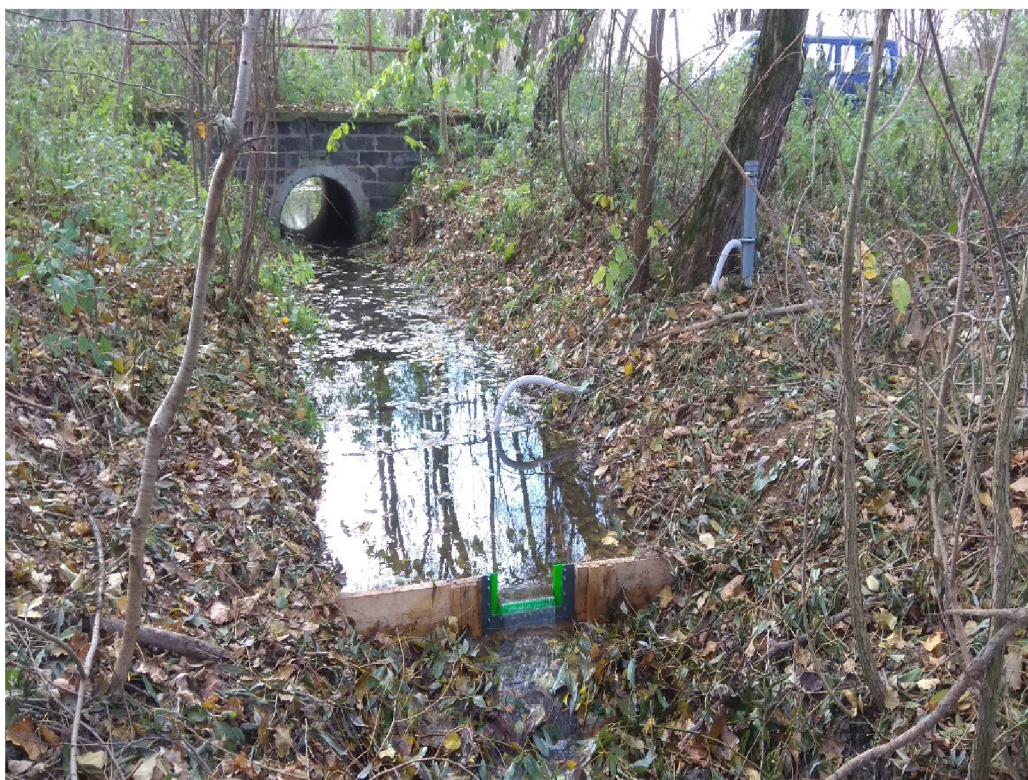
Obrázek č. 4.13 – Vodoměrný profil s online záznamovým zařízením na přítoku do Nesvačilského rybníka.
