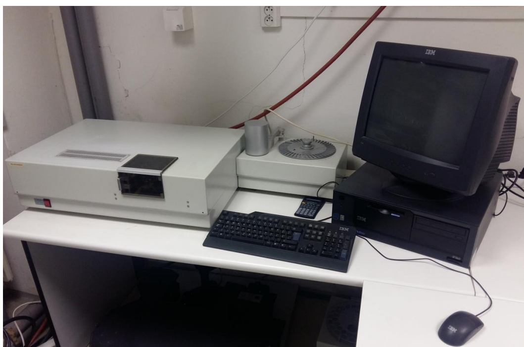
Obr. 8: Přístroj AMA 254 (foto vlastní)
