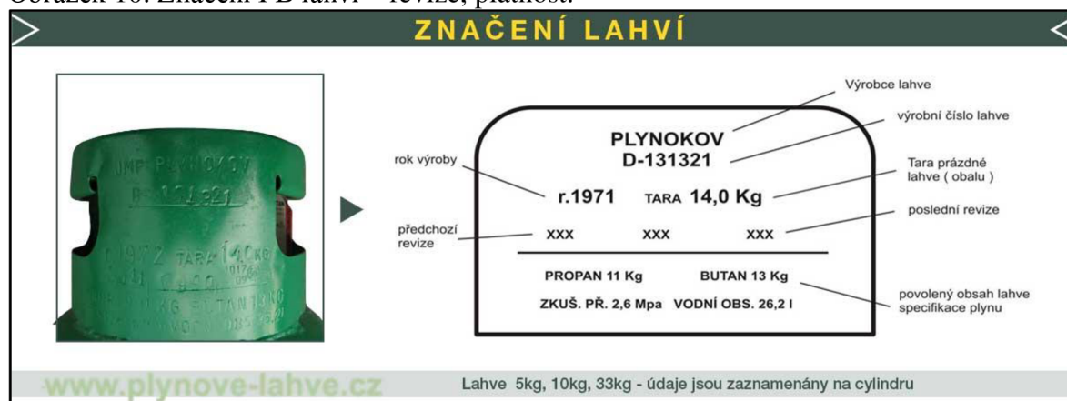
Obrázek 10: Značení PB lahví – revize, platnost.
