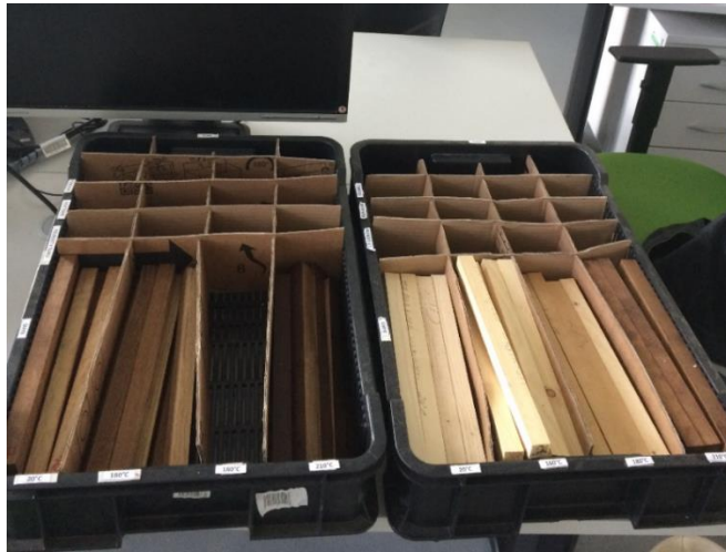
Obr. 33 Příprava zkušebních vzorků pro rázovou houževnatost a ohybových charakteristik (foto autor)
