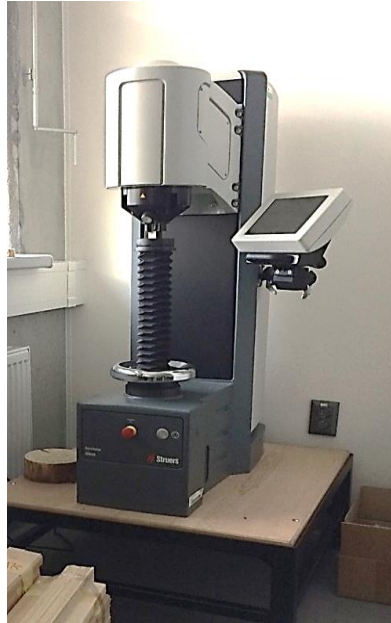
Obr. 39 Tvrdoměr Duravision-30 pro měření tvrdosti podle Brinella (foto autor)
