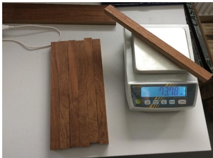
Obr. 34 Vážení vzorků pro zkoušku rázové houževnatosti a ohybových charakteristik na digitálních vahách (foto autor)
