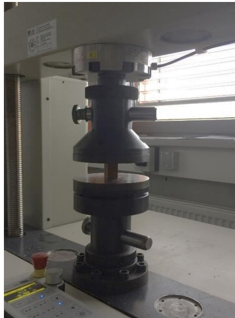
Obr. 42 Testování vzorků na pevnost v tlaku ve směru vláken
