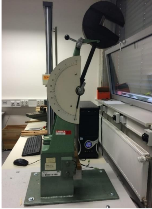
Obr. 44 Charpyho kladivo používané při zkoušení (foto autor)
