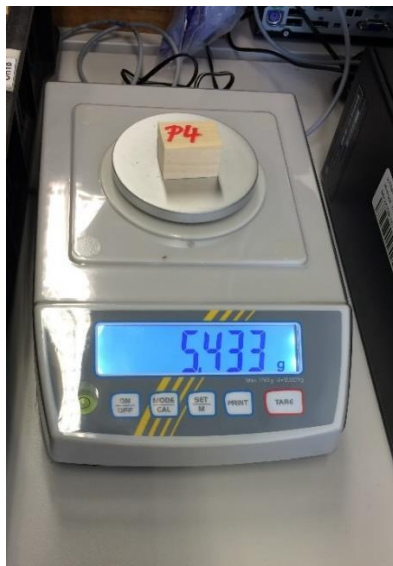
Obr. 31 Vážení zkušebních vzorků používaných pro pevnost v tlaku (foto autor)
