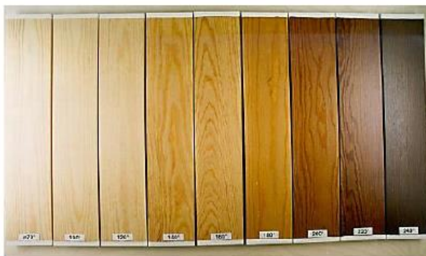
Obr. 14 Barevné změny tepelně upravovaného borovicového dřeva. Teplota úprav začíná na 70°C a dále se pohybuje po 20°C od 100°C až po 240°C. Čas tepelného upravování je 3 hodiny (ThermoWood Handbook 2003).
