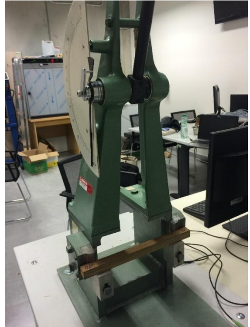
Obr. 45 Umístění zkušební vzorku na podporách kladiva (foto autor)
