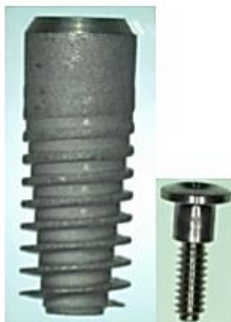
Obr. 116 Projektová dokumentace použitého implantátu a vlastní použitý implantát ve variantě nano Grade 4 (Vzorek: Ti Gr 4 CON 1 + RK + TZ) s krycím šroubkem.
