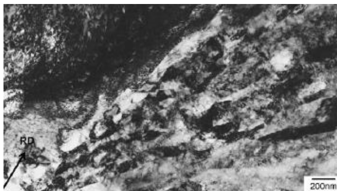
Obr. 4 Smykový pás vzniklý intenzivní deformací titanu při válcování za studena [16].
