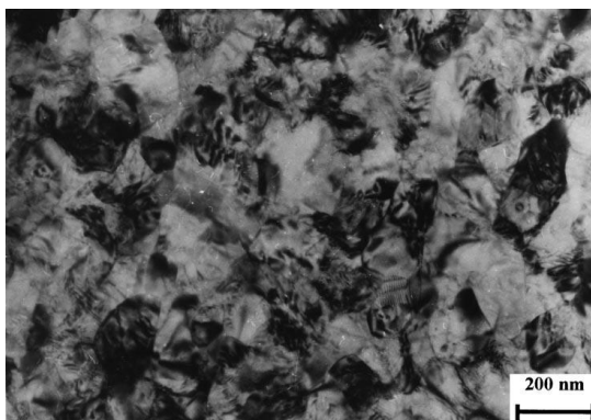
Obr. 23 Substruktura CP Ti po zpracování pomocí HCP metody [61].
