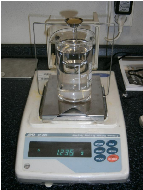
Obr. 49 Vážení zkušebních těles při zjišťování hustoty vzorků.
