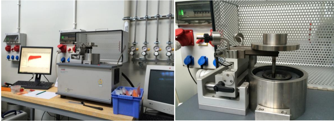
Obr. 54 Tribometr CSM, pracoviště TU Lodž.
