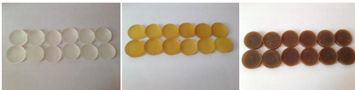
Obr. 13 Vzorky připravené pro měření tvrdosti a nasákavosti – čistá epoxidová pryskyřice – epoxidová pryskyřice s plněním 1 dsk. – epoxidová pryskyřice s plněním 10 dsk.
