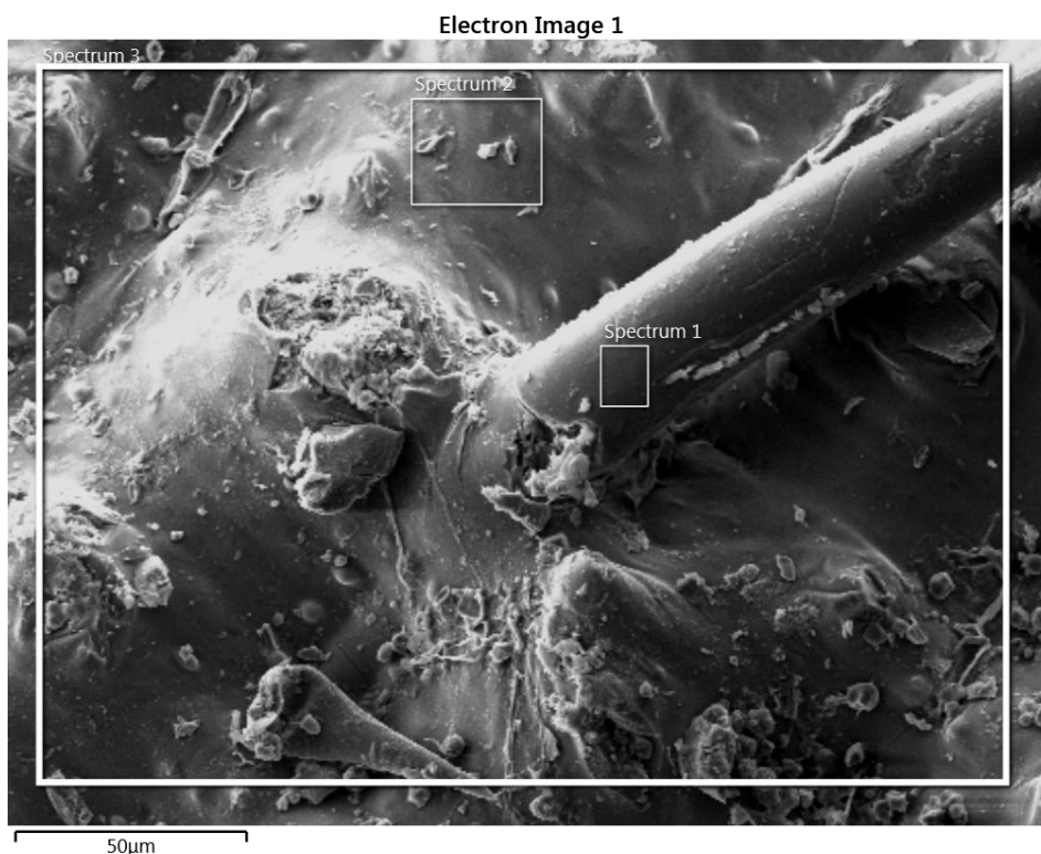
Obr. 22 Povrch rýžové slupky s naznačeným ohraničením, na kterém byla provedena EDX analýza.
