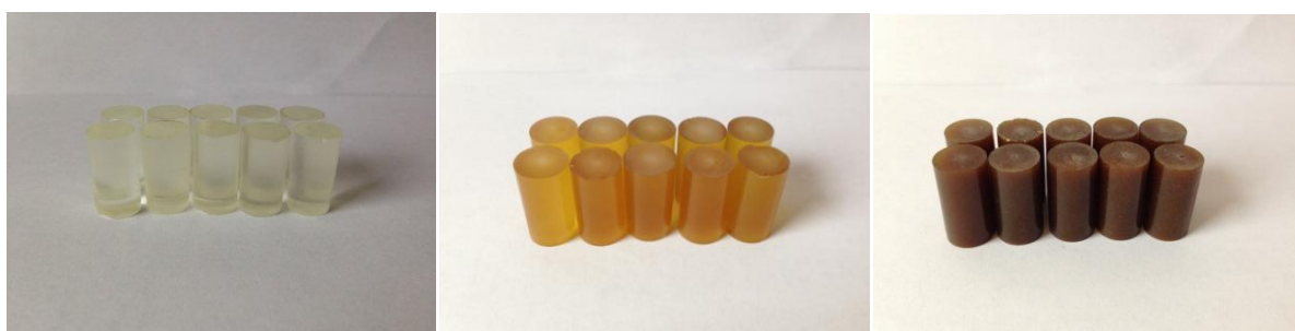
Obr. 14 Obr. X. Vzorky pro zkoušku tlakem – čistá epoxidová pryskyřice – epoxidová pryskyřice s plněním 1 dsk – epoxidová pryskyřice s plněním 10 dsk.
