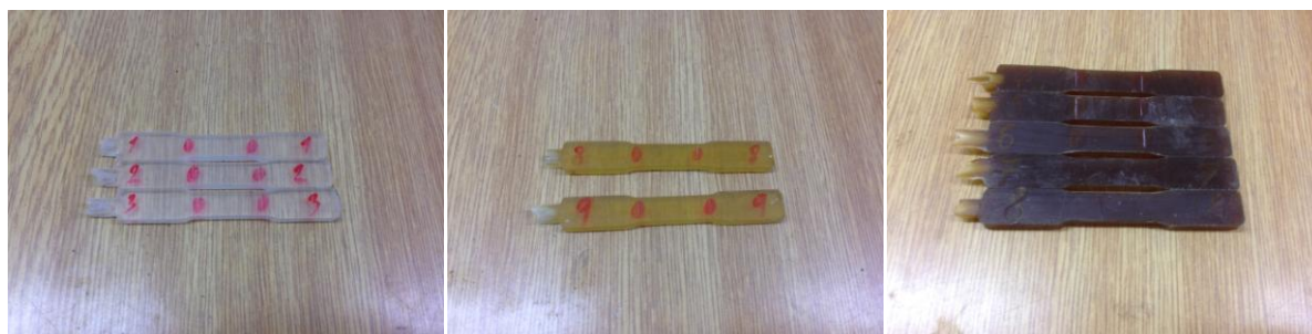
Obr. 15 Vzorky pro zkoušku tahem – čistá epoxidová pryskyřice – epoxidová pryskyřice s plněním 1 dsk – epoxidová pryskyřice s plněním 10 dsk.
