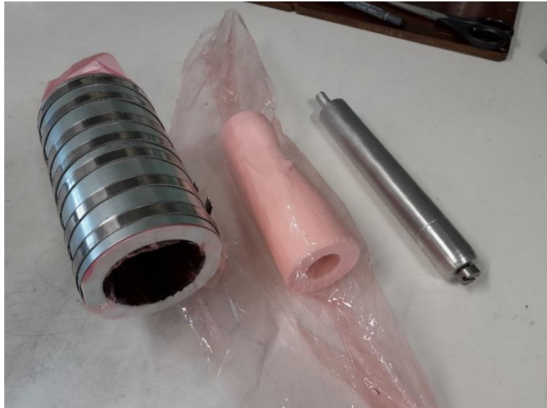
Obr. 79 Stažení ocelovými páskami.
