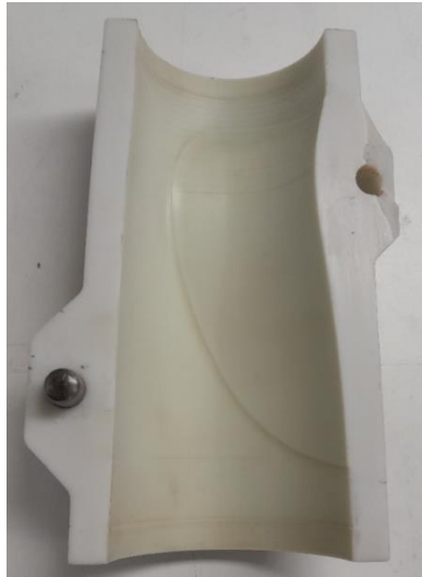
Obr. 51 Poškozená forma – vylomený kolík.
