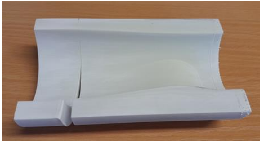
Obr. 59 Vadný výtisk – nedostatek polymeru při tisku.
