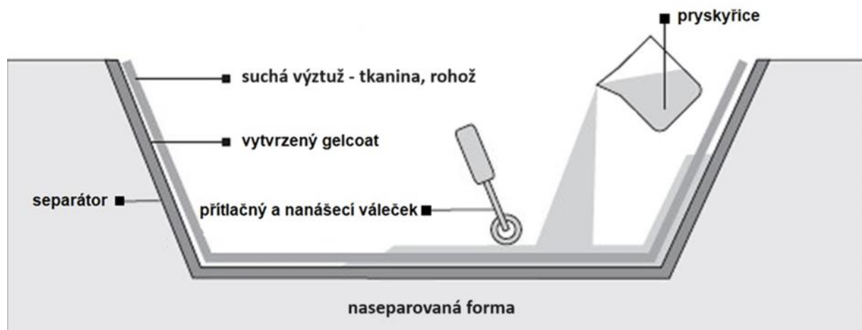
Obr. 22 Schéma metody mokrého kladení, upraveno dle [30].
