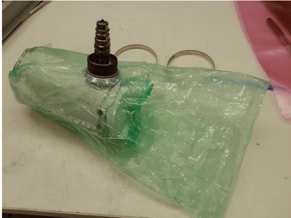
Obr. 41 Balení formy s laminátem do pytle.
