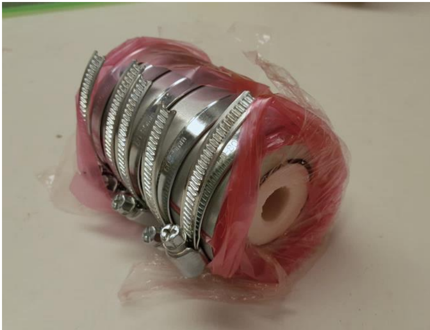
Obr. 43 Sestavená forma se silikonovým jádrem.
