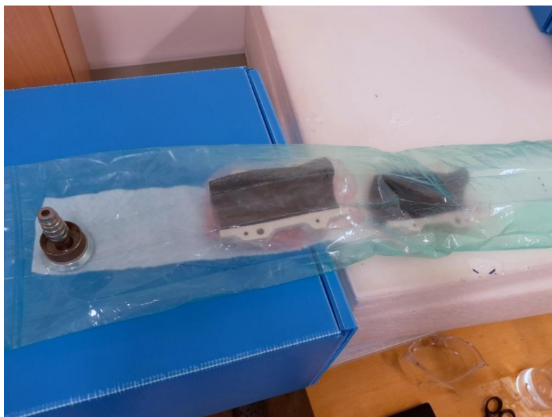
Obr. 73 Balení do vakuového pytle – debulk.
