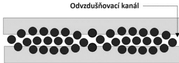
Obr. 34 Schéma mimoautoklávového prepregu, upraveno dle [49].
