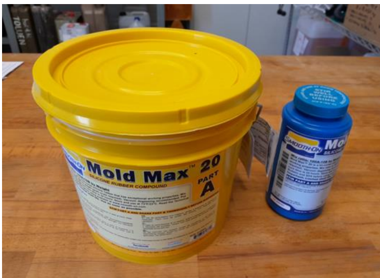
Obr. 68 Dvousložkový silikon pro výrobu jádra.
