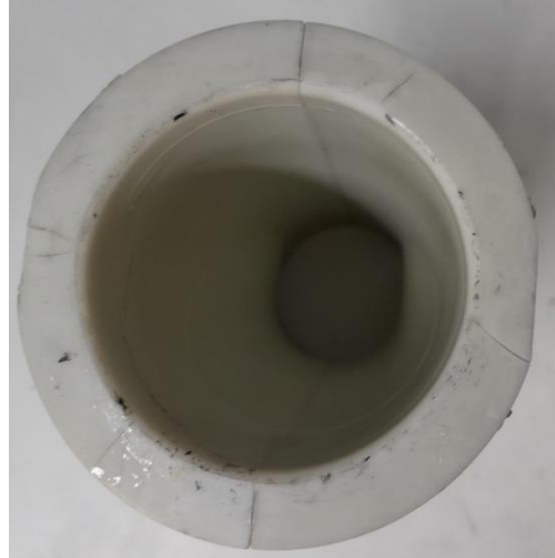
Obr. 89 Praskliny na čele.
