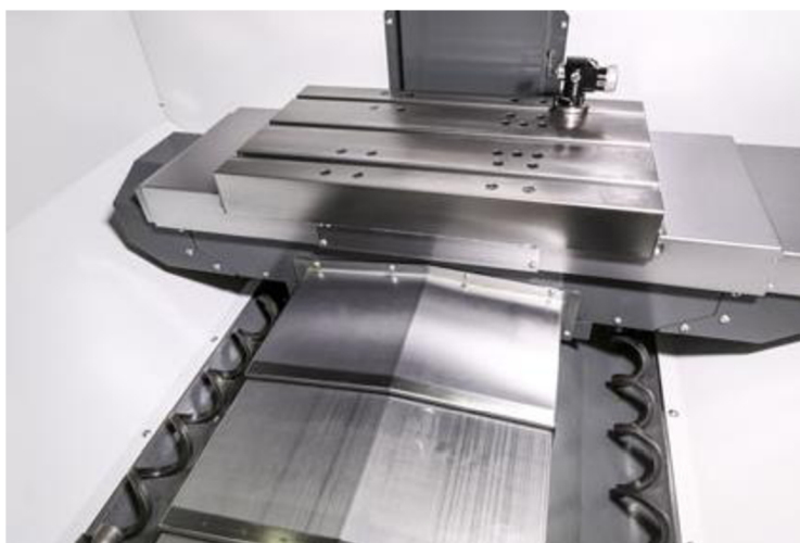
Obr. 16) Odvod třísek pomocí šnekového dopravníku [28]
