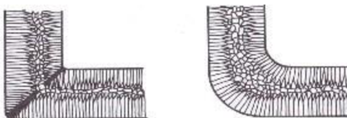
Obr. 33) Vliv hrany na strukturu odlitku [19]
