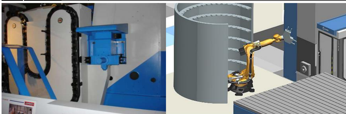
Obr. 15) AVN – vpravo řetězový zásobník od firmy AiTEK, vlevo zásobník nástrojů se stacionárním robotem firmy SKODA Machine Tool
