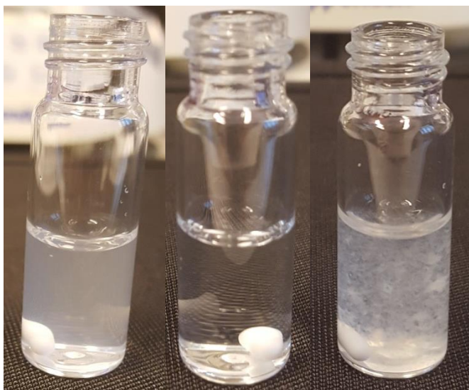
Obrázek P 7: Systém Hya + 8 Arg-HCl. Zleva 9 kDa Hya + 8 Arg-HCl po 8 přidavcích, stejný systém po 11 přidavcích. Vpravo systém 1 540 kDa Hya + 8 Arg-HCl po 20 přidavcích.
