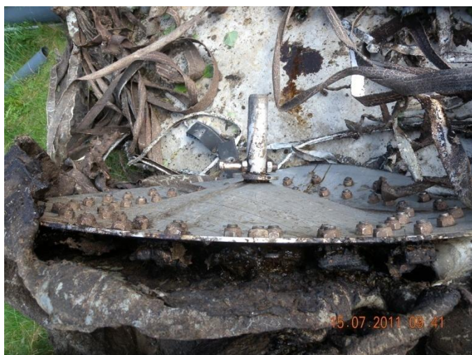
Fotografie č.2, příklad mechanického působení na ocelový prvek, který byl součástí zastřešení fermentoru bioplynové stanice, archiv HZS JČK, autor fotografie Martin Petrák
