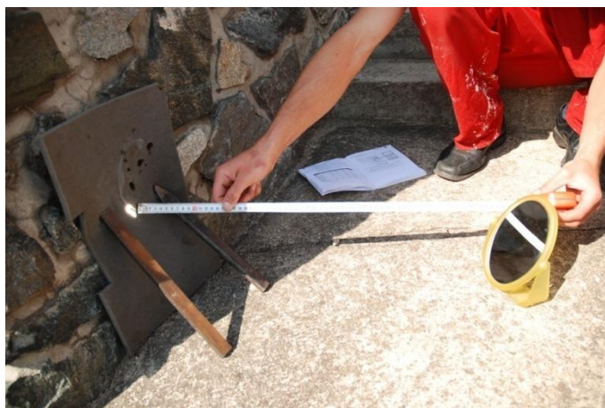
Fotografie č.1, vyšetřovací pokus se zapálením lehčeného polyuretanu v ohniskové vzdálenosti, archiv HZS JČK, autor fotografie Martin Petrák
