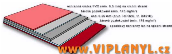
Obr. 6.7 struktura plechu Viplanyl
