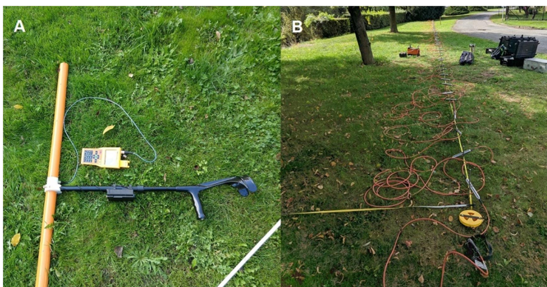
Obr. 13. A) CMD-Mini Explorer 6L, B) ERT prospekce, foto autor.
