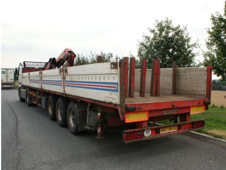
Obr. 6.10 Valník MAN TGA 24.410 6x2 s přívěsem PANA V NV 35 HR a s hydraulickou rukou PALFINGER 21000 [6.2]
