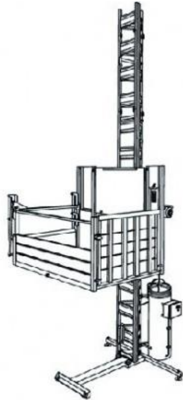
Obr. 6.26 Stavební výtah GEDA 500 Z/ZP
