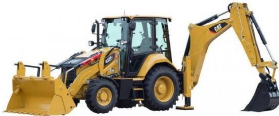
Obr. 6.7 Rýpadlo- nakladač CAT 432F2 [6.23]
