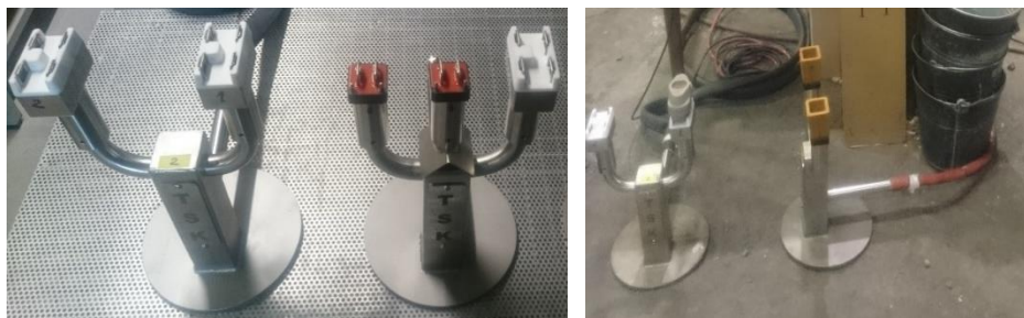
Obr. 3-28 Stativy pro měření termální analýzy - stativ pro dva kelímky AccuVo a druhý kombinovaný pro 1 AccuVo a 2 Open Cup [14] (vlevo) a konkrétní stativy při měření v MR (vpravo)
