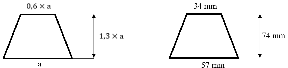
Obr. 3-10 Profil odlučovače strusky vytvořený dle vzorce (17)
