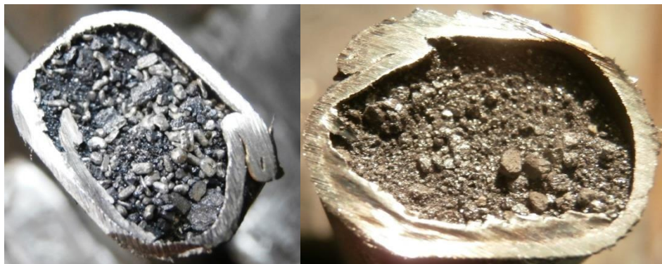
Obr. 2-7 Řez plněným profilem používaným v MR ( vlevo modifikátor Progelta LSK 13412BS, vpravo očkovadlo Progelta WIN 13A )
