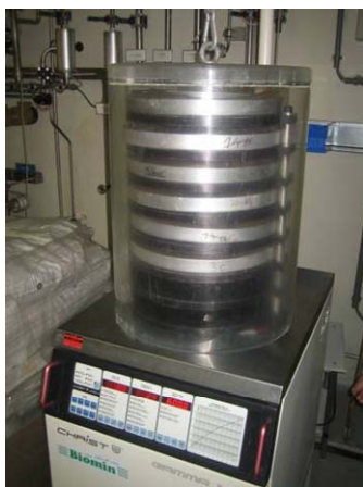
Obr. 4-5: Sušení vzorku za zmrazena (a) a sestava sít při síťovém rozboru (b)
