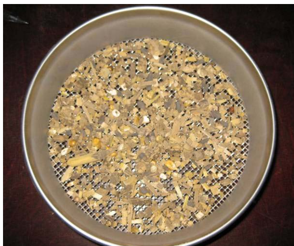
Obr. 4-6: Frakce větší než 4mm (suspenze A) po suchém (a) a mokrém (b) síťovém rozboru
