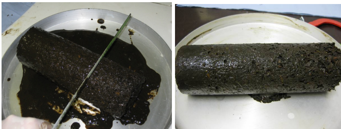
Obr. 5-16: Sedimentační test (suspenze A vlevo, suspenze B vpravo)
