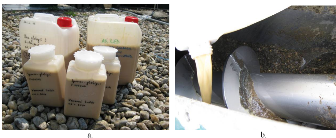
Obr. 5-28: Suspendované spóry Bacillus globigii – stopovač (vlevo), dávkování stopovače spolu se substrátem pomocí dopravního šneku do fermentoru B (vpravo)
