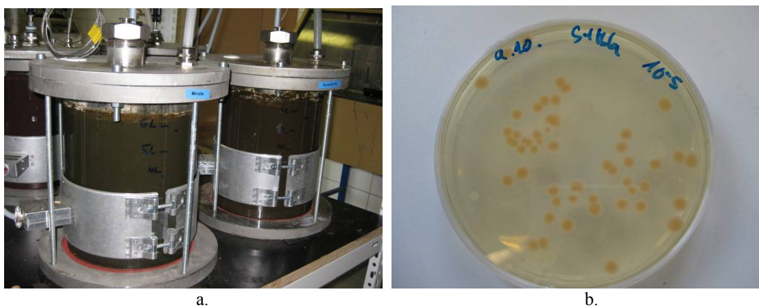
Obr. 5-29: Fermentační suspenze z testovacích fermentorů (a) a z ní izolované spóry Bacillus globigii (b)
