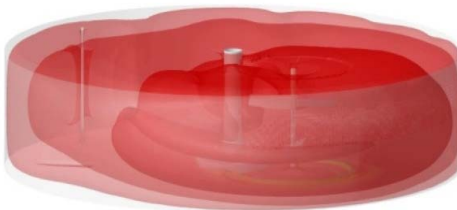
Obr. 5-40: CFD simulace prostorové distribuce substrátu ve fermentoru A (POHN ET AL., 2011A)
