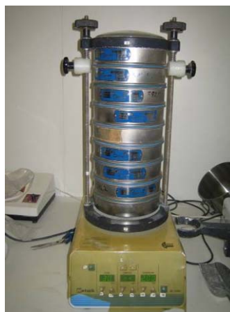
Obr. 4-5: Sušení vzorku za zmrazena (a) a sestava sít při síťovém rozboru (b)
