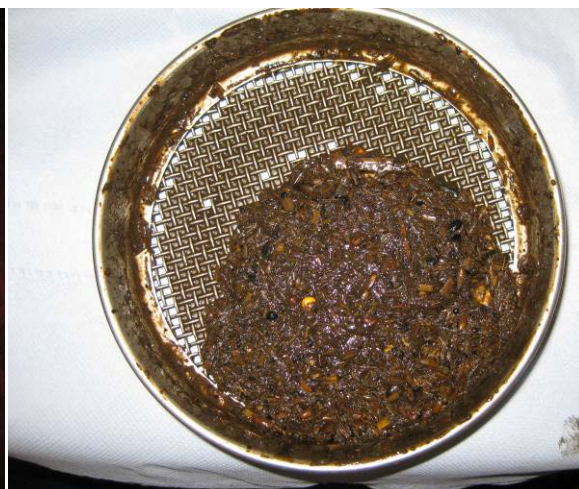
Obr. 4-6: Frakce větší než 4mm (suspenze A) po suchém (a) a mokrém (b) síťovém rozboru
