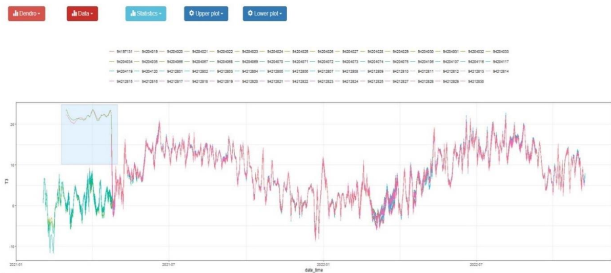
Obr. 4. Průběh čištění dat za pomoci balíčku PloTeR. Data v modrém výběru bylo nutno odstranit z důvodu viditelně chybných hodnot způsobených měřeními čidel ještě před umístěním na výzkumnou plochu.
