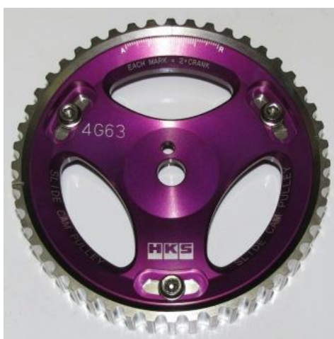
Obr. 27 Kolo vačkové hřídele umožňující změnu časování [12]
