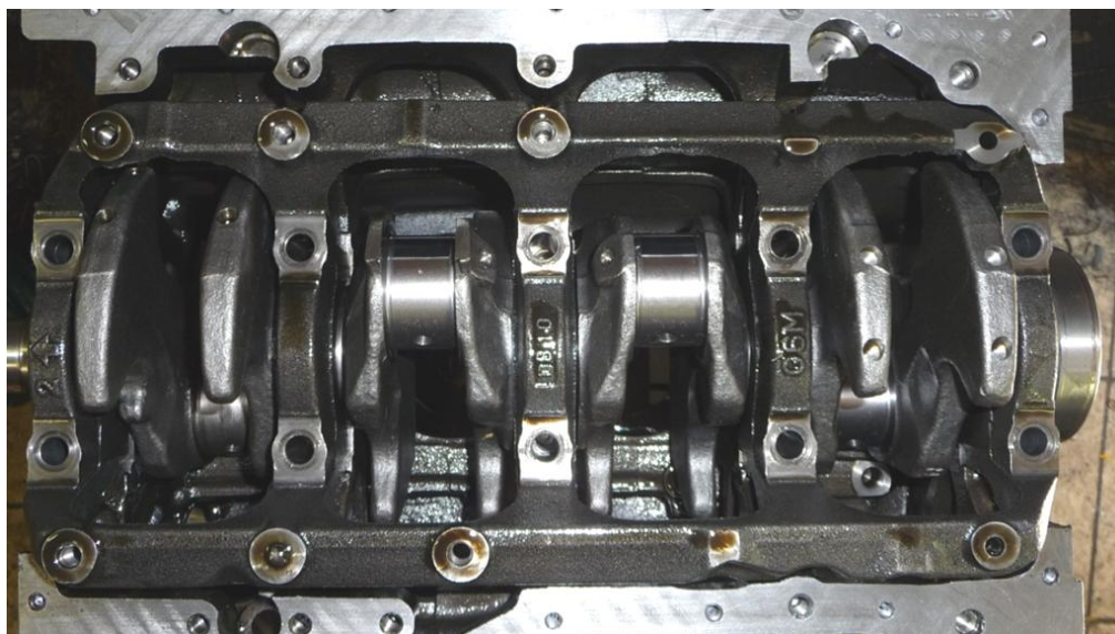
Obr. 23 Uložení klikového hřídele v bloku [13]
