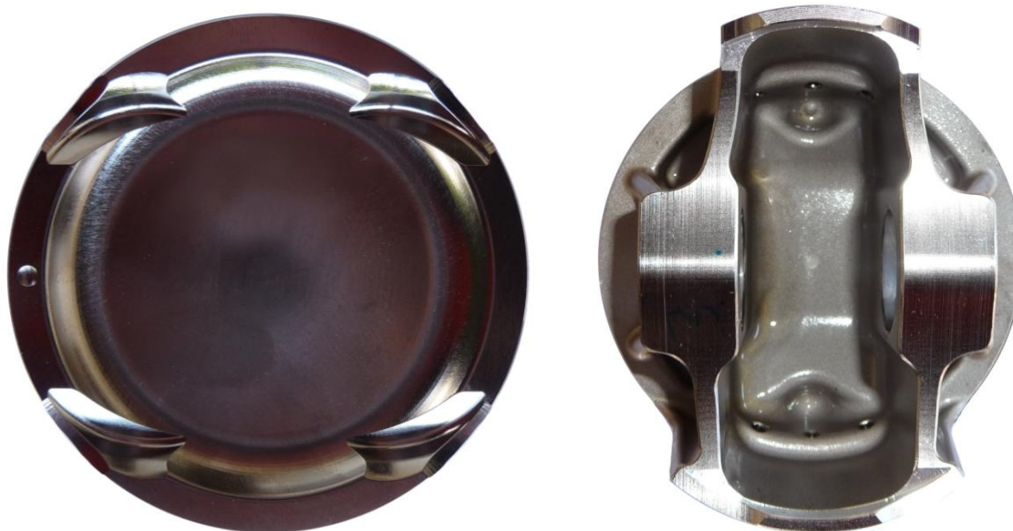
Obr. 25 Kovaný píst pro upravený motor [16]
