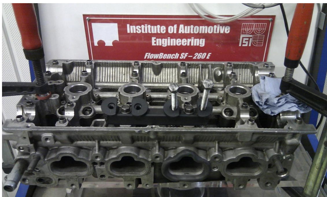
Obr. 32 Měření tlakových ztrát v sacím kanále
