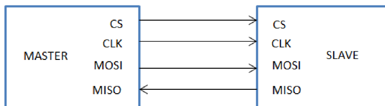
Obrázek 14 - Obecné zapojení komunikace SPI
