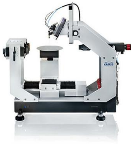
Obrázek 6 Analizátor tvru kapky Krüss (Krüss [2016])
