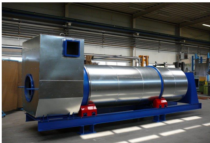
Obrázek 13 – Bubnová sušárna pilin (Brikliis, 2015)
