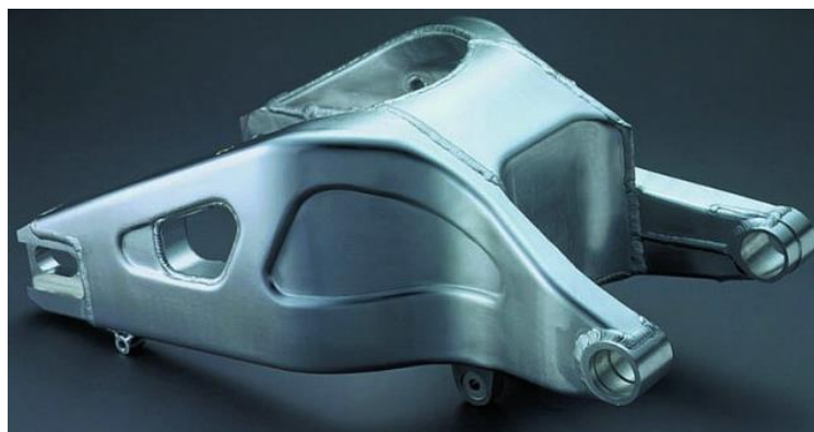
Obr. 29 Dvouramenná zadní vidlice (Rollinger, 2006)
