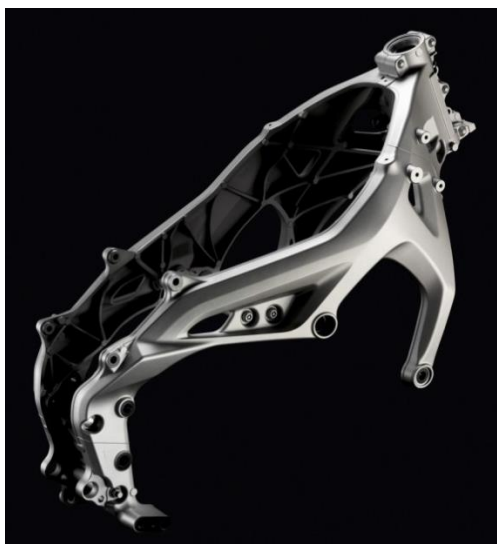
Obr. 17 Odlévaný rám Yamaha MT 09 (Motorkari, 2013)
