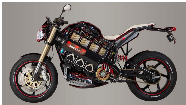
Obr. 35 Řez motocyklem Brammo Empulse R (Madson, 2016)
