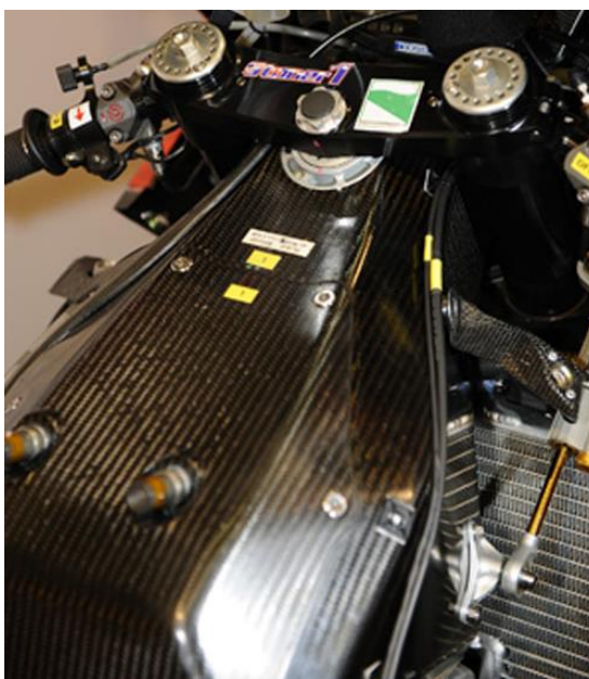
Obr. 18 Karbonový rám Ducati Desmosedici GP9 (Visordown 2009)
