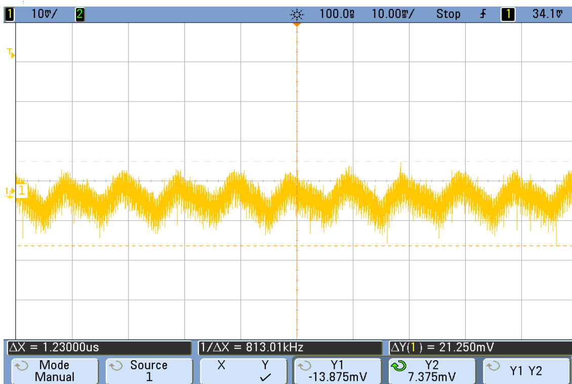
Obr. 41: Zvlnění výstupního napětí při výstupním proudu 2,5 A.
