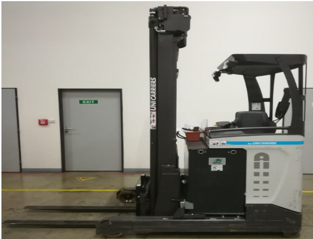
Obr. 1.9 Manipulační vozík s boční instalací zdvihového zařízení
