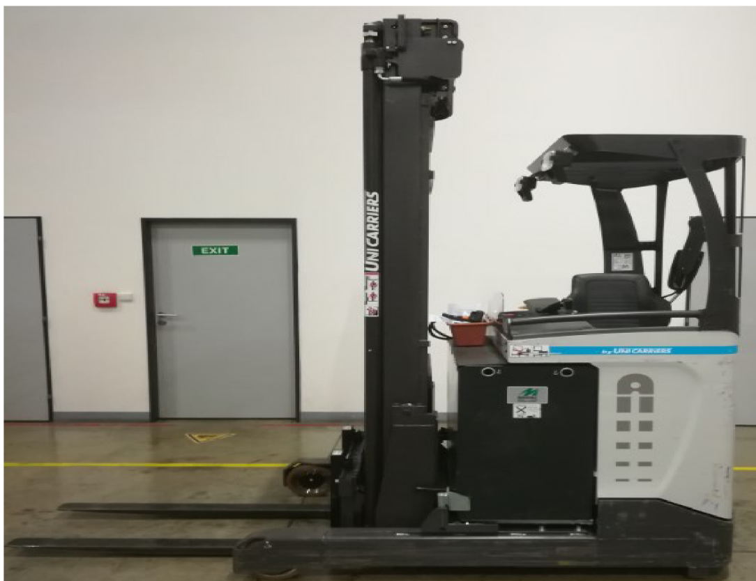
Obr. 1.9 Manipulační vozík s boční instalací zdvihového zařízení
