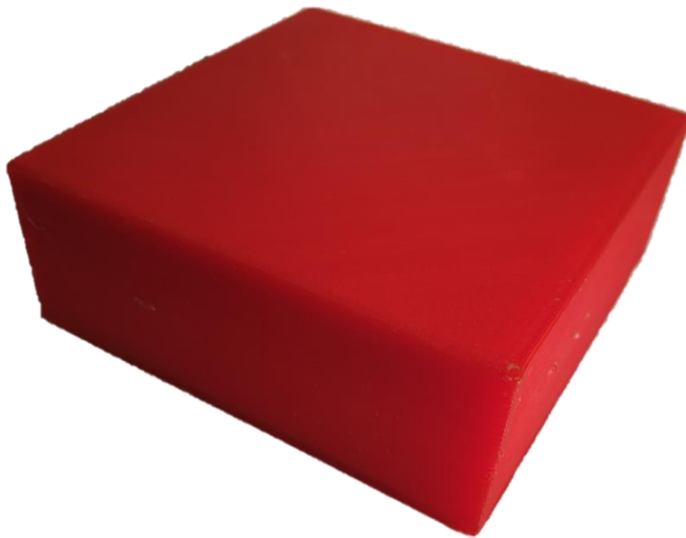
Obrázek 35 Vzorek PETG 80 x 80 x 30 mm
