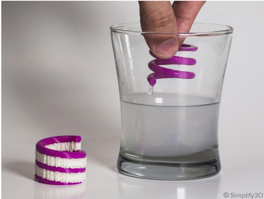
Obrázek 7 Výtisk s podpůrnou konstrukcí PVA [20]
