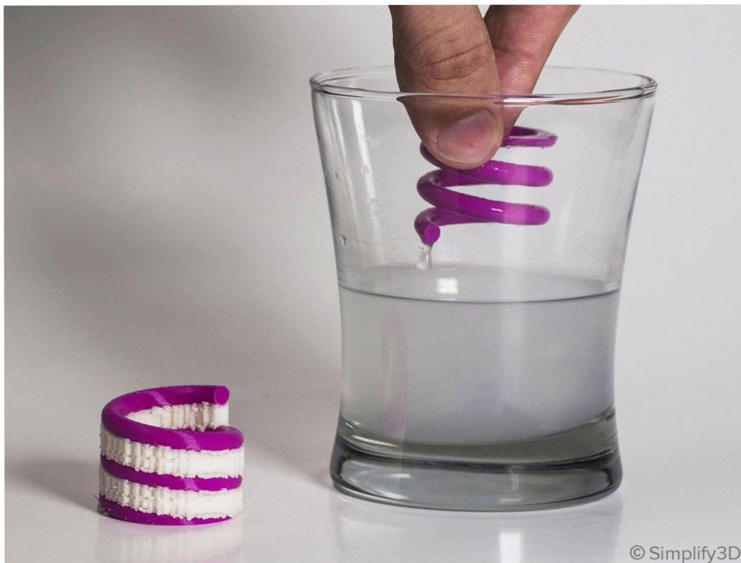
Obrázek 7 Výtisk s podpůrnou konstrukcí PVA [20]
