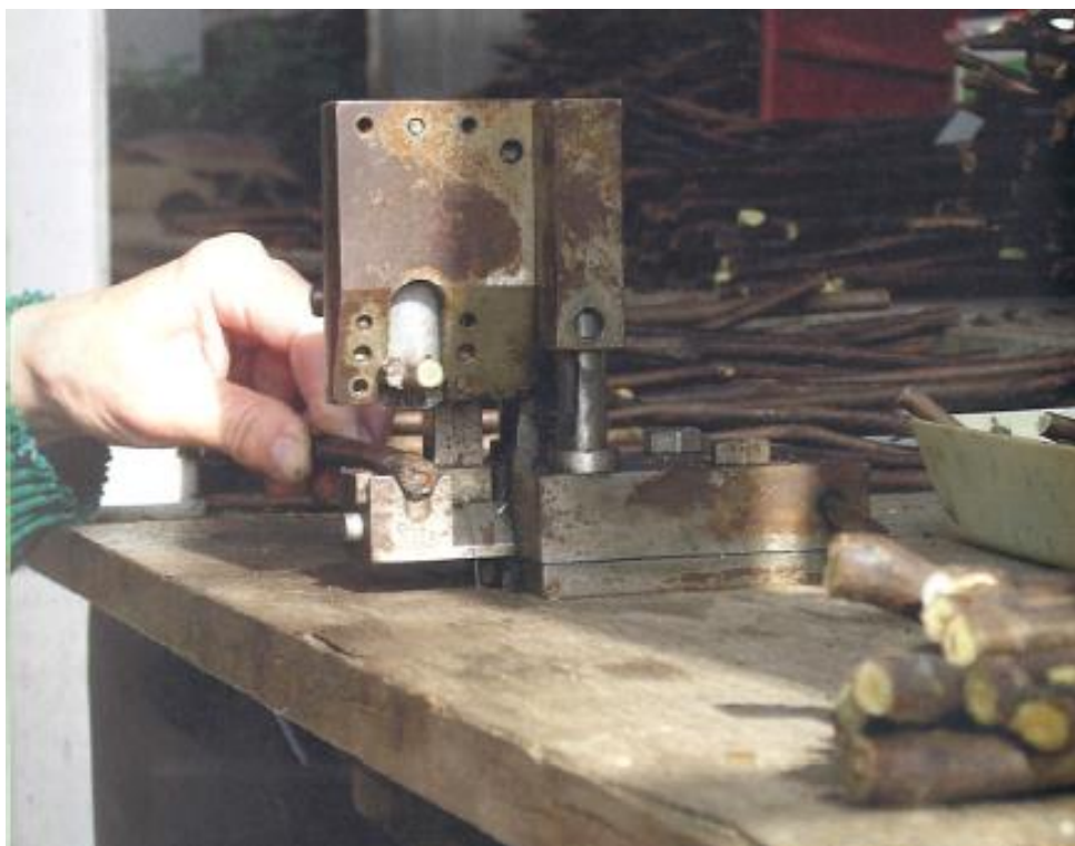
Obr. 13 Roubovací strojek (PAVLOUŠEK, 2011)
