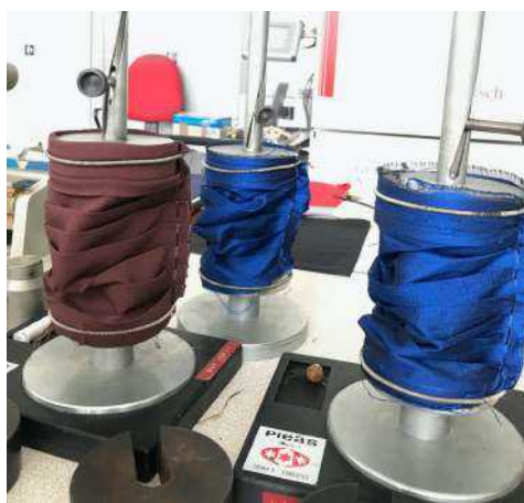
Obrázok 45: Vyplisované vzorky upevnené na dutom valci
