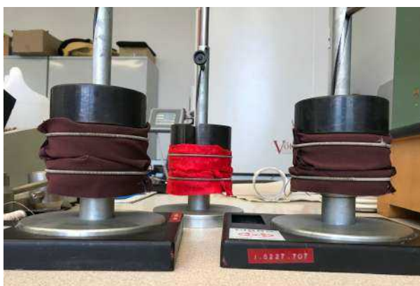
Obrázok 25: Zaťaženie materiálu 2 kg závažím po dobu 20 min.
