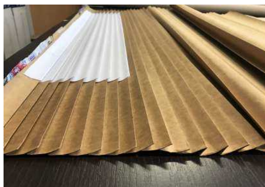
Obrázok 44: Otvorená forma s vyplisovaným materiálom
