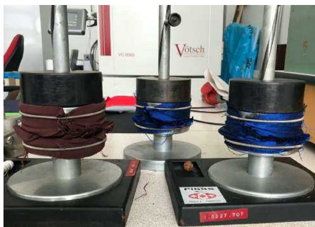
Obrázok 46: Vyplisované vzorky zaťažené závažím po dobu 20 min.
