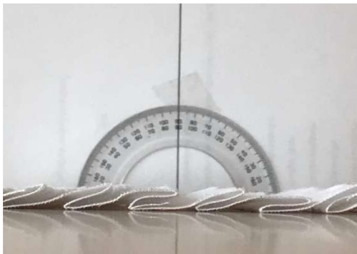
Bavlna - 10° (uhol, ktorý zvierá záhyb s podložkou)
