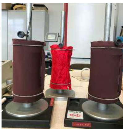
Obrázok 24: Upevnenie materiálu na dutom valci
