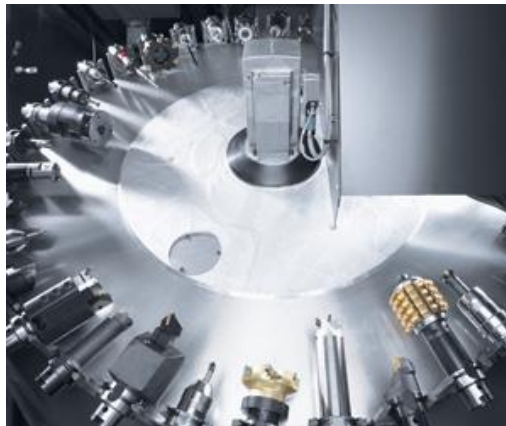
Obr. 4.16: Hvězdicový zásobník s nástroji orientovanými k ose otáčení zásobníku [DMG MORI] [30]
