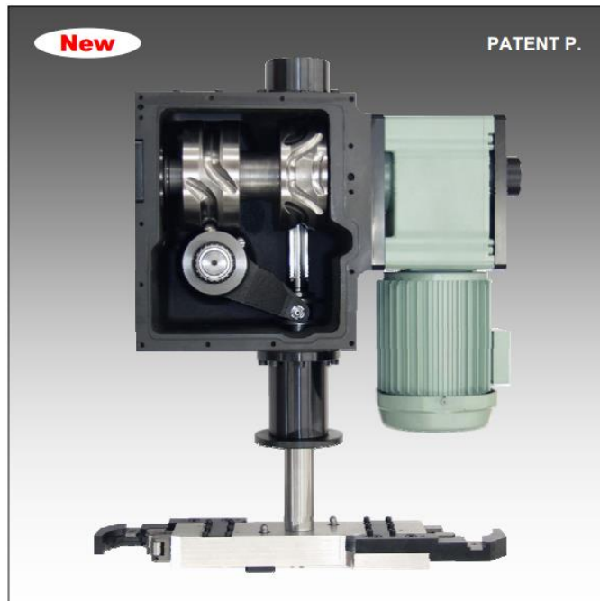
Obr. 5.6: Mechanismus výměníku nástrojů [Pascal corporation] [42]
