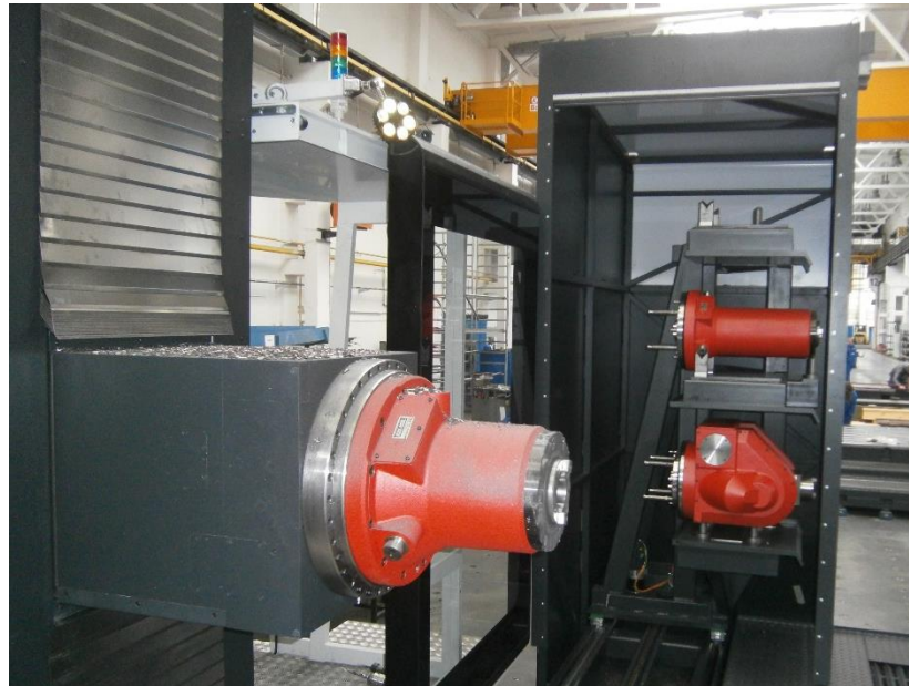
Obr. 6.1: Výměnné vřetenové hlavy a skladovací zásobník [TOS Kuřim–OS, a. s.]
