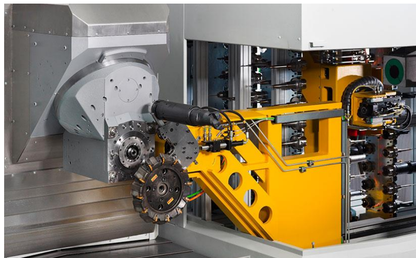
Obr. 5.8: Manipulátor spolupracující s regálovým zásobníkem [BURKHARDT+ WEBER Fertigungssysteme GmbH] [41]
