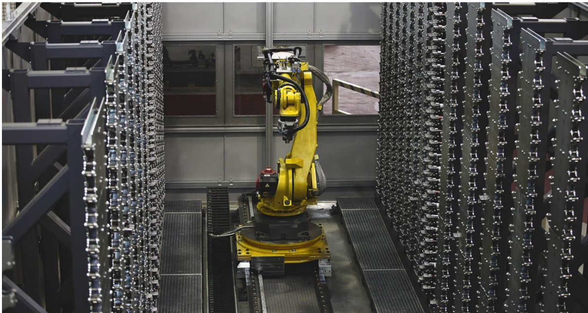
Obr. 4.28: „Stěny“ úložných míst sestavených z hřebenů [RILE Group] [38]
