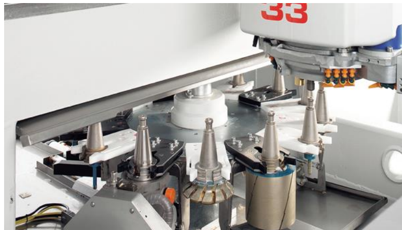
Obr. 5.2: Bubnový zásobník nástrojů konstruován pro pick-up výměnu [40]
