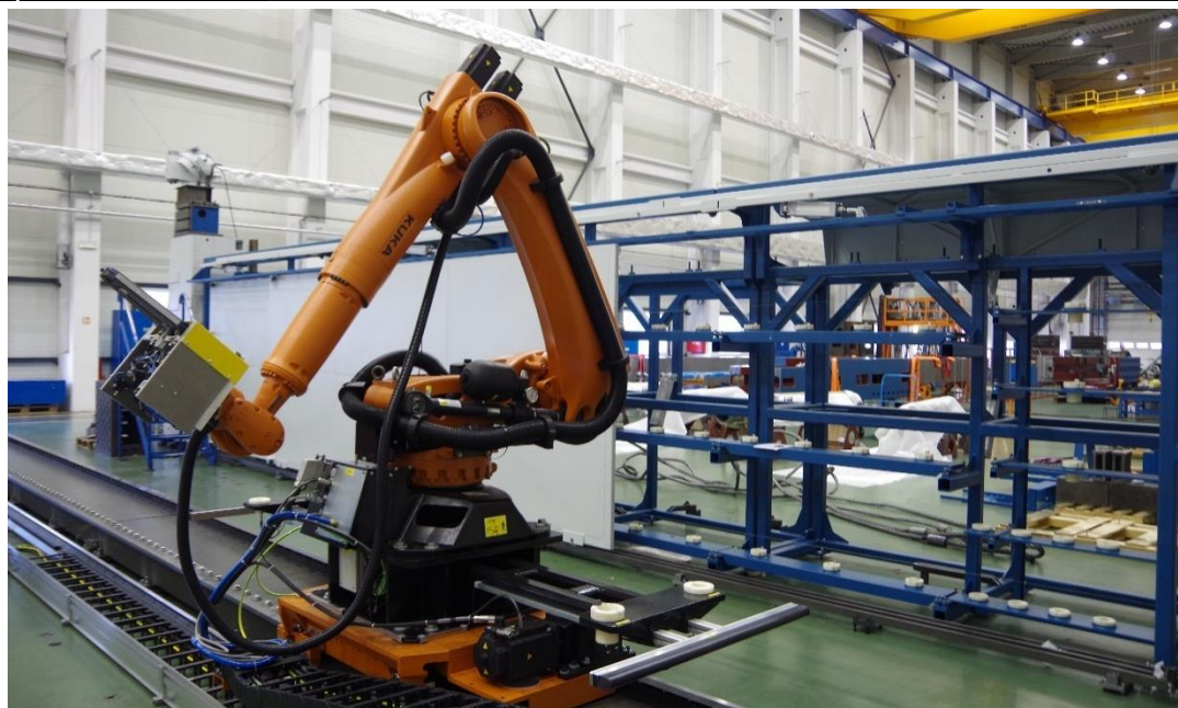
Obr. 5.9: Průmyslový robot firmy KUKA na lineárním pojezdu. V pozadí je patrný skladovací regalový zásobník [TOS Kuřim – OS, a. s.].
