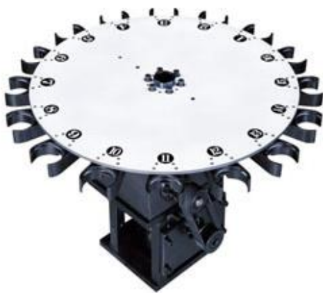
Obr. 4.13: Bubnový zásobník se svislou osou rotace [CHEN SOUND INDUSTRIAL Co., Ltd.] [28]
