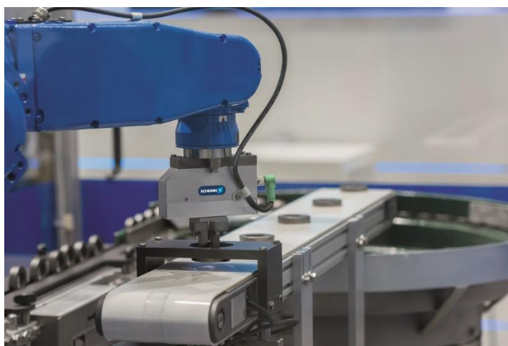
Obr. 12.7: Užití pásového dopravníku pro manipulaci s obrobky v součinnosti s průmyslovým robotem [Schunk GmbH & Co. KG] [89]
