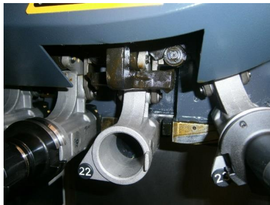
Obr. 4.15: Kapsa řetězového zásobníku se sklopným mechanismem v referenční pozici [DMG MORI]
