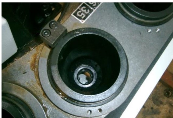
Obr. 3.3: Kapsa na nástrojový držák ISO s pojistnými kuličkami [TOS Kuřim – OS, a. s.]
