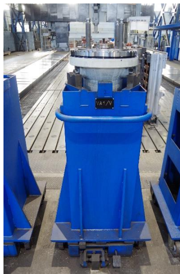
Obr. 3.1 b): Přípravek, sloužící jako místo pro odkládání výměnné nástrojové hlavy (celkový pohled) [TOS Kuřim – OS, a. s.]
