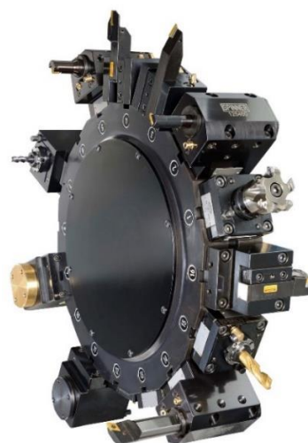
Obr. 4.7: Uložení nástrojů na obvodu otočného disku revolverové hlavy [Spinner] [22]
