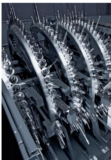
Obr. 4.17: Seřazení pěti disků zásobníků v řadě [DMG MORI DMU Series] [31]
