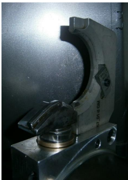
Obr. 5.3: Koncový efektor dvouramenného výměníku se zajišťovacím mechanismem [DMG MORI]
