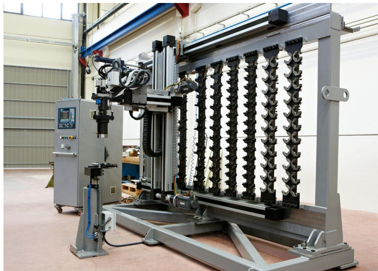
Obr. 5.7: Manipulátor nasazený jako zakladač nástrojů do regálového zásobníku [SIDEPALSA] [32]
