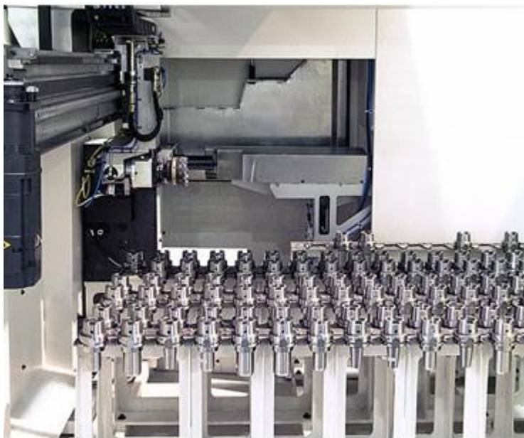
Obr. 4.27: Regálový zásobník plošného provedení s portálovým manipulátorem nástrojů [Hüller Hille] [37]
