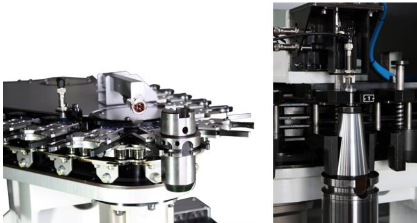
Obr. 7.3: Řešení detekce přítomnosti nástroje [SANJET INTERNATIONAL Co., Ltd] [45]
