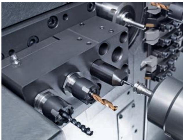
Obr. 4.12: Nástroje uložené pevně ke stroji [DMG MORI Sprint 20|5] [27]
