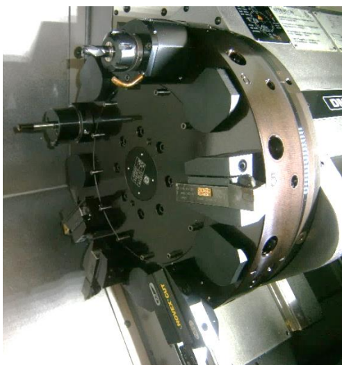
Obr. 4.6: Uložení nástrojů na čele otočného disku revolverové hlavy [nástroj Sauter, stroj DMG MORI]
