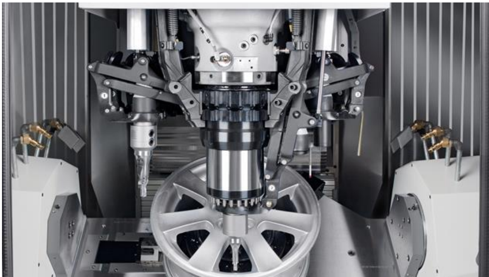
Obr. 4.26: Pohled na kinematický pákový mechanismus výměníku nástroje [CHIRON-WERKE GmbH & Co. KG] [36]
