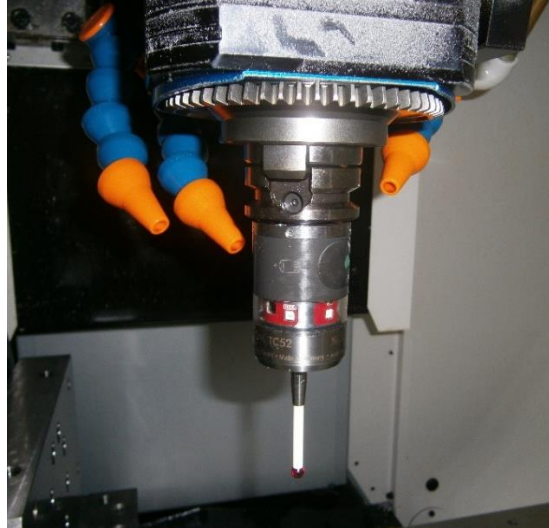
Obr. 4.24: Detail ozubeného kola, které je spojeno s vřetenem a slouží k náhonu rotace zásobníku
