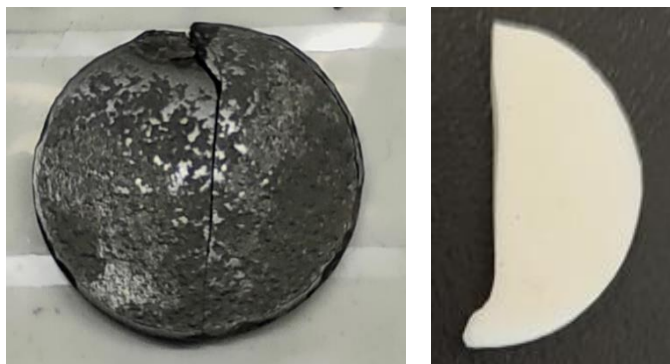
Obr. 19: Znečištění vzorku uhlíkem Obr.20: Vzorek po vyžhání
