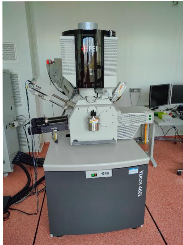
Obr 15: Rastrovací elektronový mikroskop - FEI Veriou 460L (VERIOS) Thermo Fisher Scientific, United States
