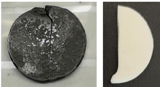
Obr. 19: Znečištění vzorku uhlíkem Obr.20: Vzorek po vyžhání
