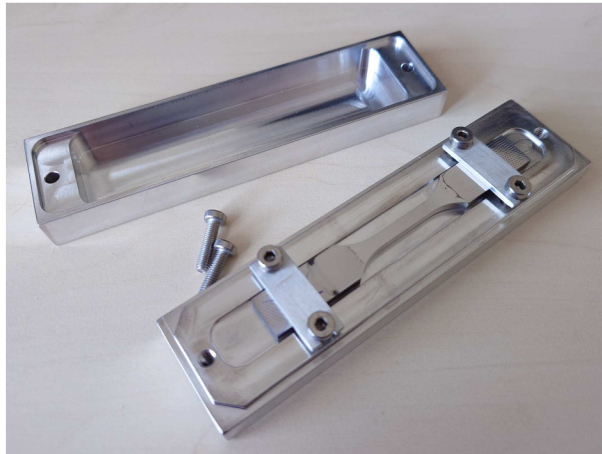
Obrázek 22: Krabička pro uchování vzorků vlastní konstrukce se založeným vzorkem.
