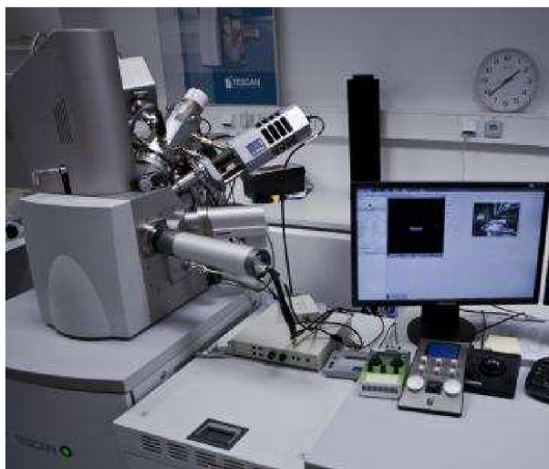
Obrázek 23: Elektronový mikroskop Tescan Lyra 3 [26].
