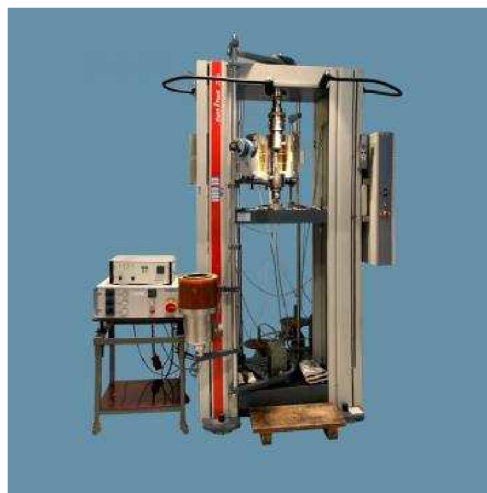
(b) Elektromechanický zkušební stroj ZWICK Z50 [25].
