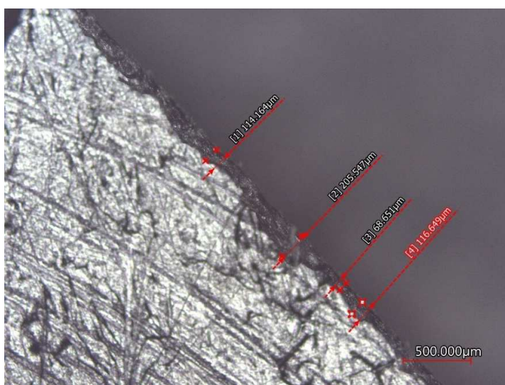
Obrázek 31: Delaminace na Keyence – detail s hodnotami
