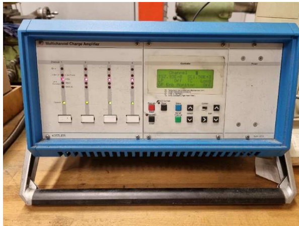
Obrázek 20: Piezoelektrický dynamometr KISTLER – nábojový zesilovač
