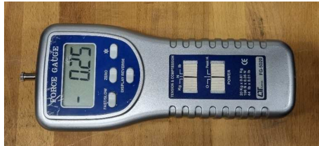
Obrázek 22: Siloměr sloužící ke kalibraci piezoelektrického dynamometru KISTLER
