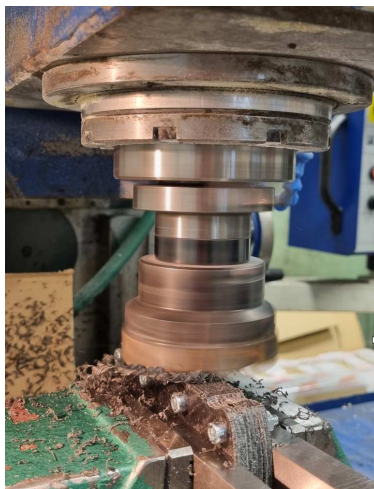
Obrázek 18: Obrábění boční hrany vzorku – zarovnání nerovností
