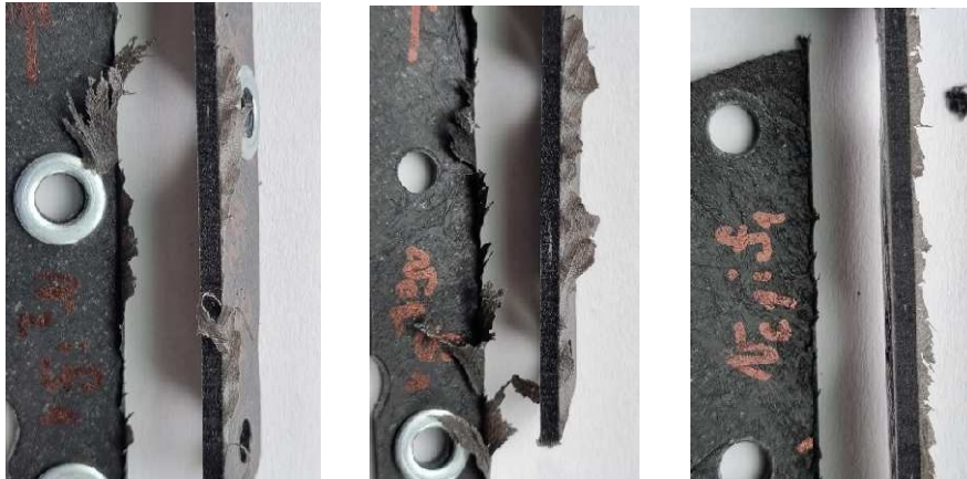
Obrázek 36: Delaminace vzniklé v průběhu experimentu – nebylo možné využití měření na Keyence z důvodu velkých ořepů
