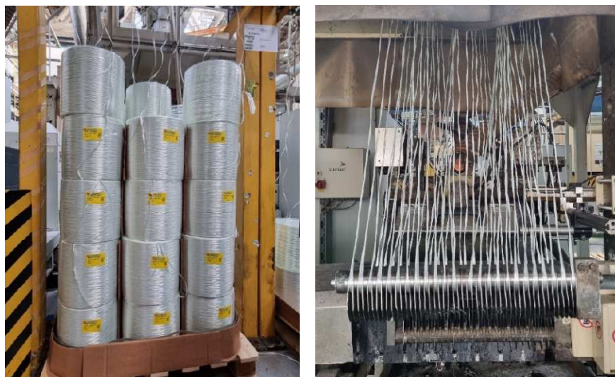
Obrázek 12: Vstupní materiál – skelné vlákno + ukázka technologie jeho zpracování
