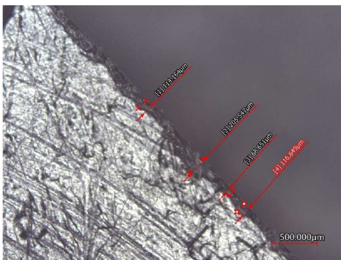
Obrázek 31: Delaminace na Keyence – detail s hodnotami
