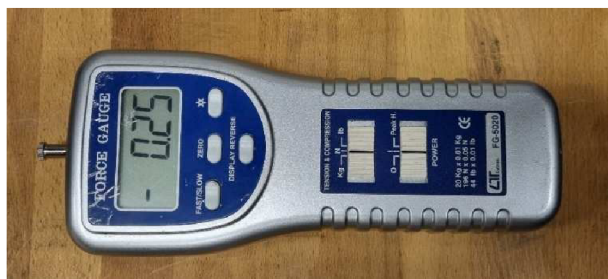
Obrázek 22: Siloměr sloužící ke kalibraci piezoelektrického dynamometru KISTLER
