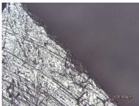
Obrázek 30: Delaminace na Keyence
