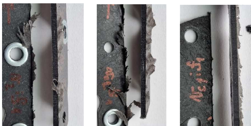
Obrázek 36: Delaminace vzniklé v průběhu experimentu – nebylo možné využití měření na Keyence z důvodu velkých otřepů
