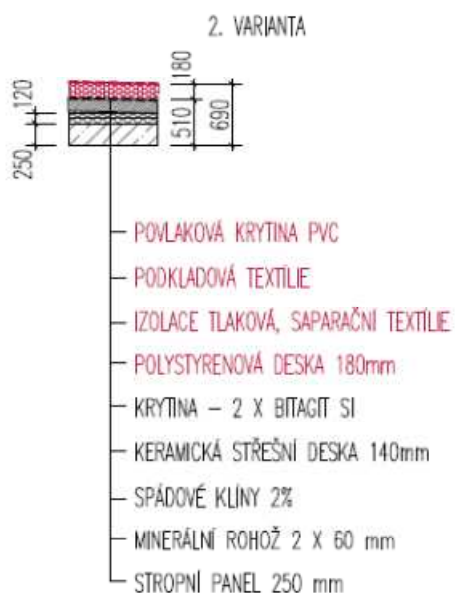
Obr. 3.2.2.3 2. varianta střešní konstrukce
