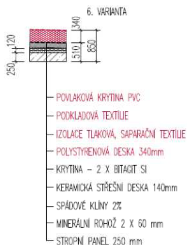
Obr. 3.2.2.7 6. varianta střešní konstrukce
