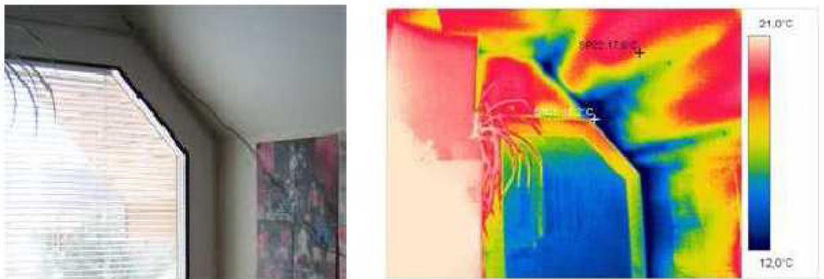
Obr. 1.4.6 Fotografie a termovizní snímek v interiéru podkroví, nadpraží francouzského okna. [2 str. 9]
