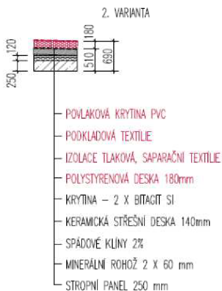
Obr. 3.2.2.3 2. varianta střešní konstrukce
