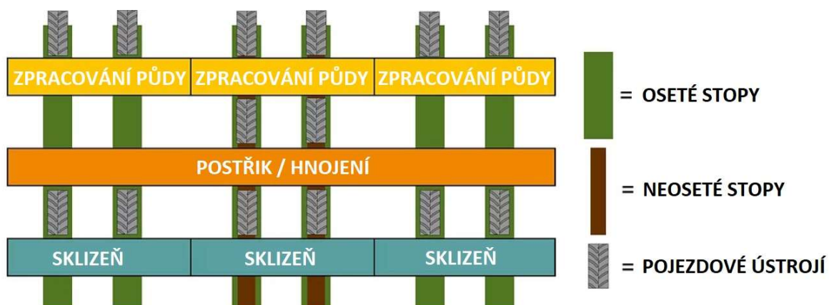
Obrázek 6: Jízdní stopy při využití systému řízených přejezdů [23] (upraveno)
