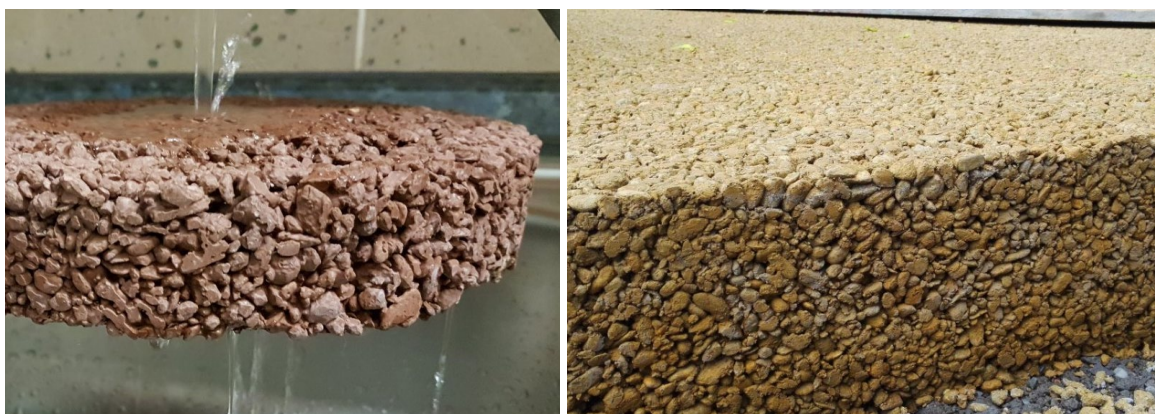
Obr. 5.24 Ukázka propustnosti betonu (vlevo) a vrstva propustného betonu (vpravo) [85]
