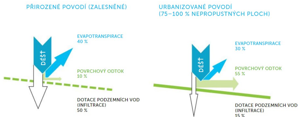
Obr. 2.1 Porovnání odtoku srážkových vod [3]
