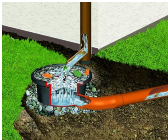
Obr. 5.6 Filtrační podokapový hrnec [33]
