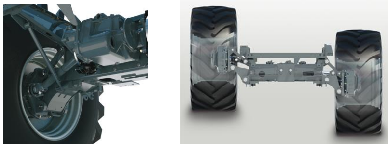
Obrázek 17, 18 – Příčné vyrovnávání sklízecí mlátičky Fendt ParaLevel (Dostupné z: http://www.fendt.com )
