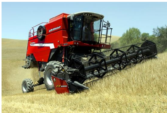
Obrázek 16 – Podélné vyrovnávání sklízecí mlátičky Laverda (Dostupné z: http://www.bisosedlec.cz )
