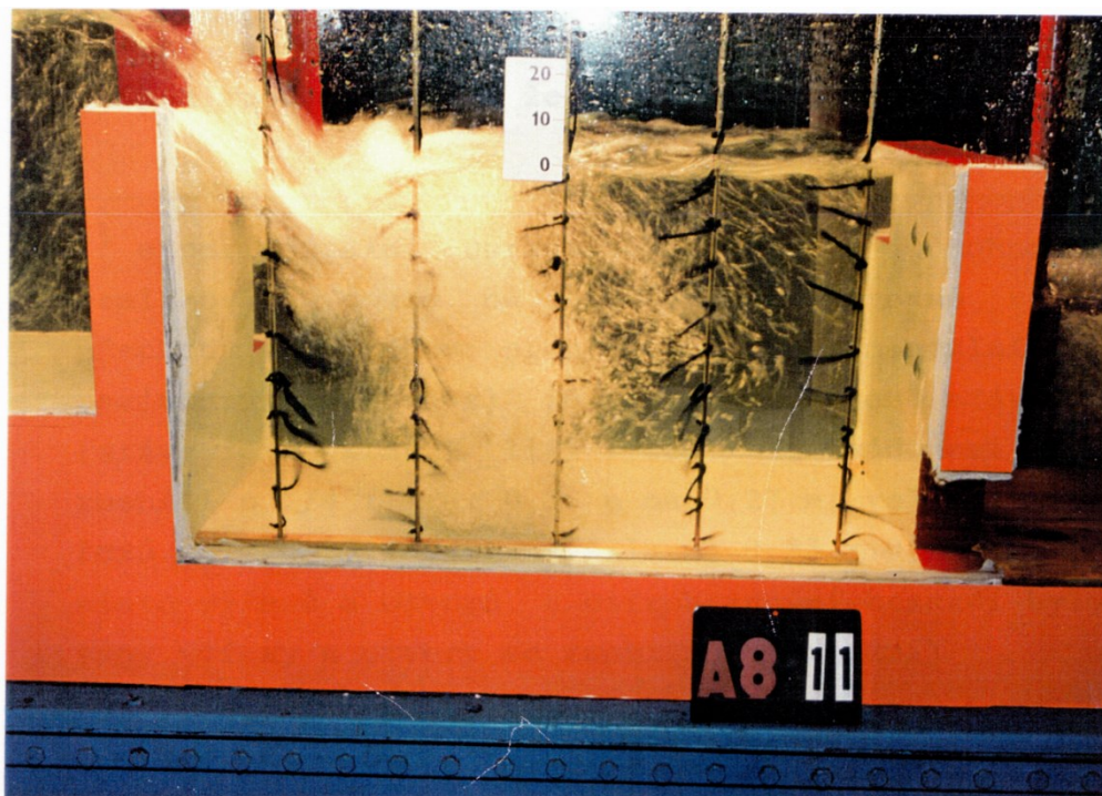
Obr. O-7 – Model rybího přechodu, který nám pomocí bavlnek ukazuje směr a druh proudění vody v korytě RP (Libý J., 1995a)
