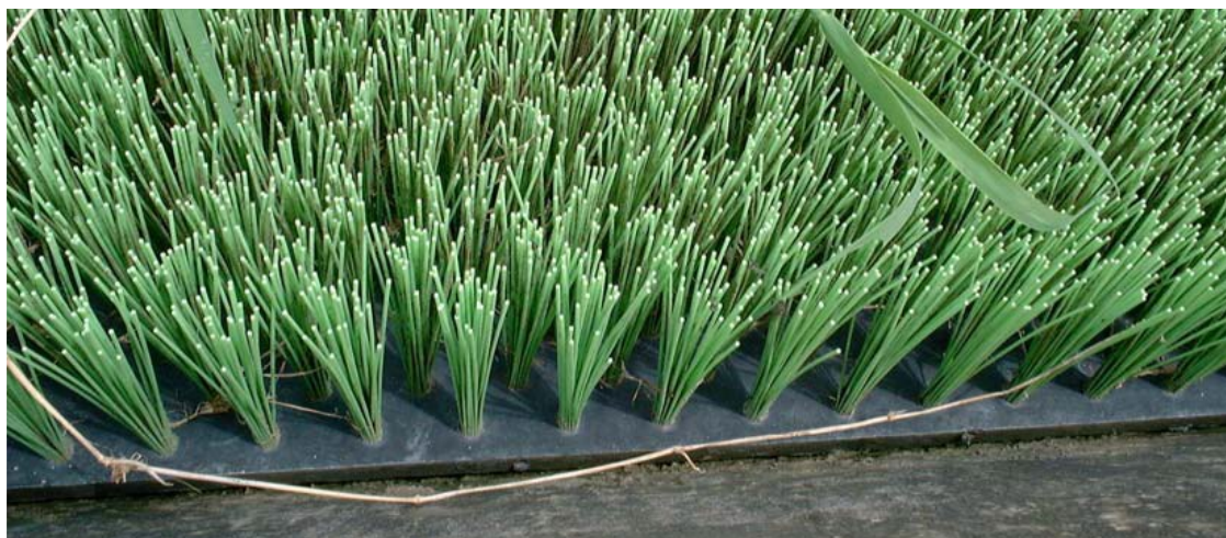
Obr. č. 6 – svazky štětín, jako tzv. šplhající substrát, který tvoří základ úhořího žebříku (Elver and eel passes, 2011)
