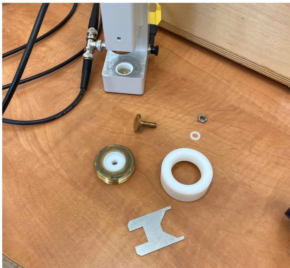
Obrázek 22 Jednotlivé části elektrod (vlastní fotografie)
