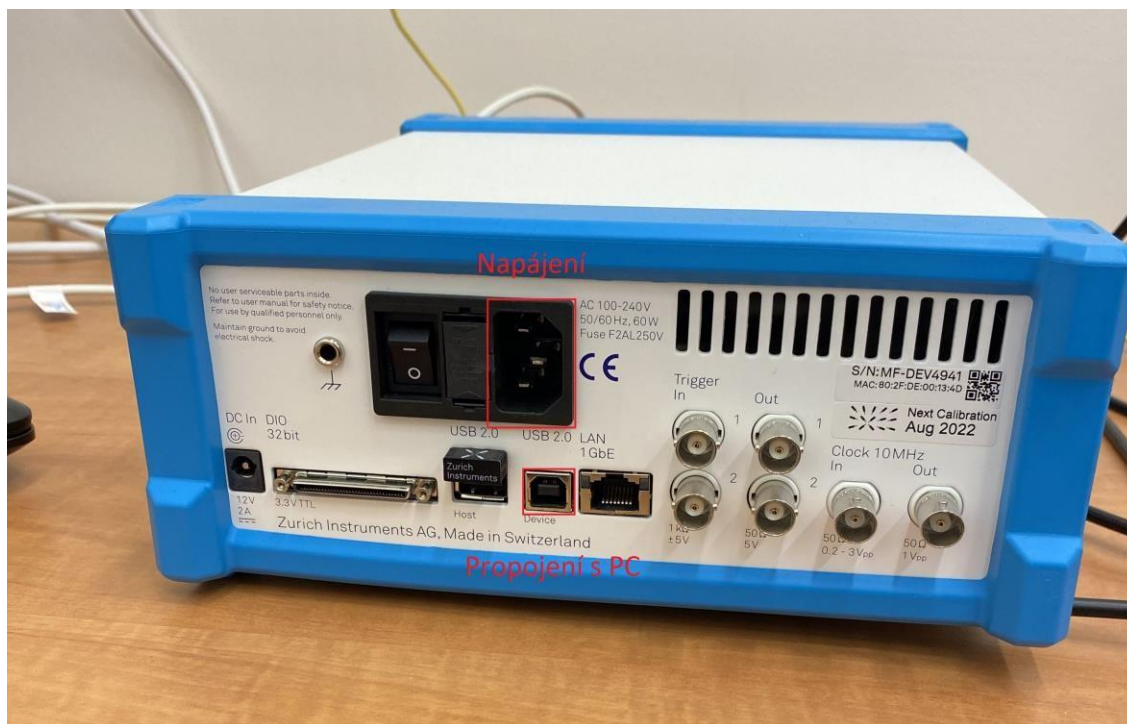
Obrázek 19 MFLI propojení s PC a napájení (vlastní fotografie)
