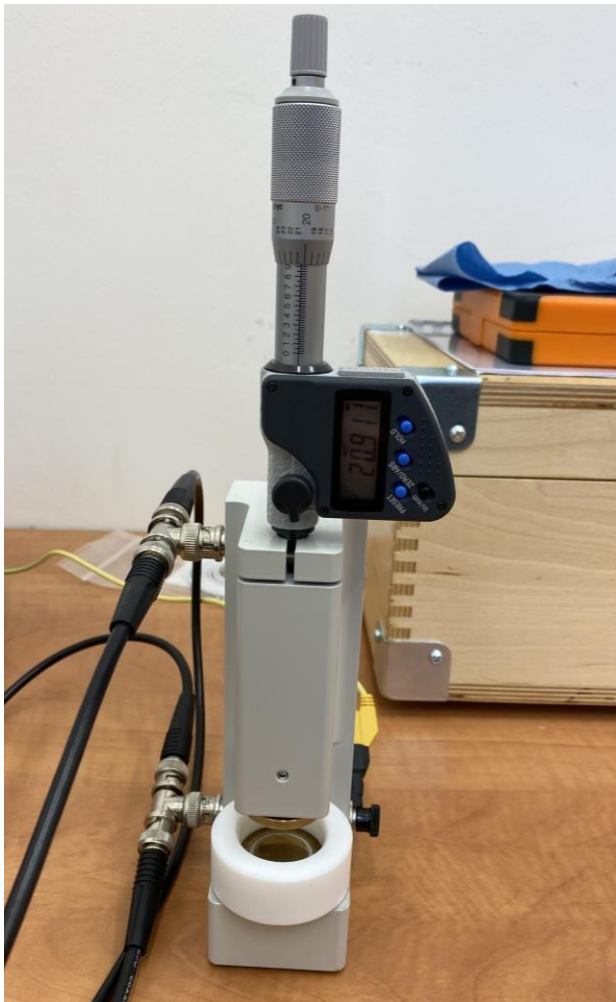
Obrázek 17 Držák na vzorky při měření (vlastní fotografie)
